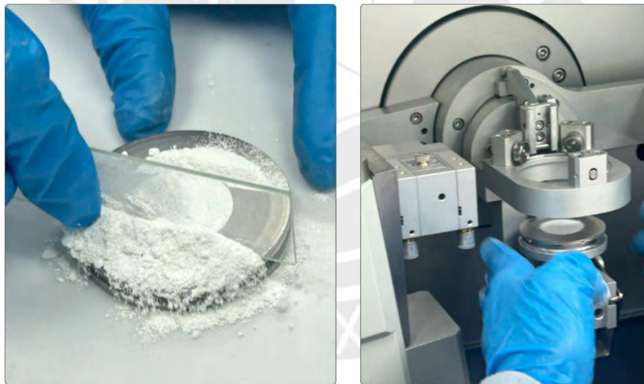
Figura 12. Preparación de muestra de dióxido de titanio para análisis por difracción de rayos X. Autoría propia.
