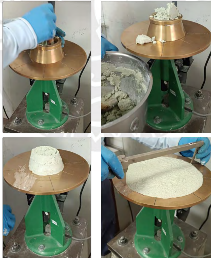
Figura 9. Pasos para realizar la prueba de medición de flujo del mortero de cemento (de izquierda a derecha). Autoría propia.
