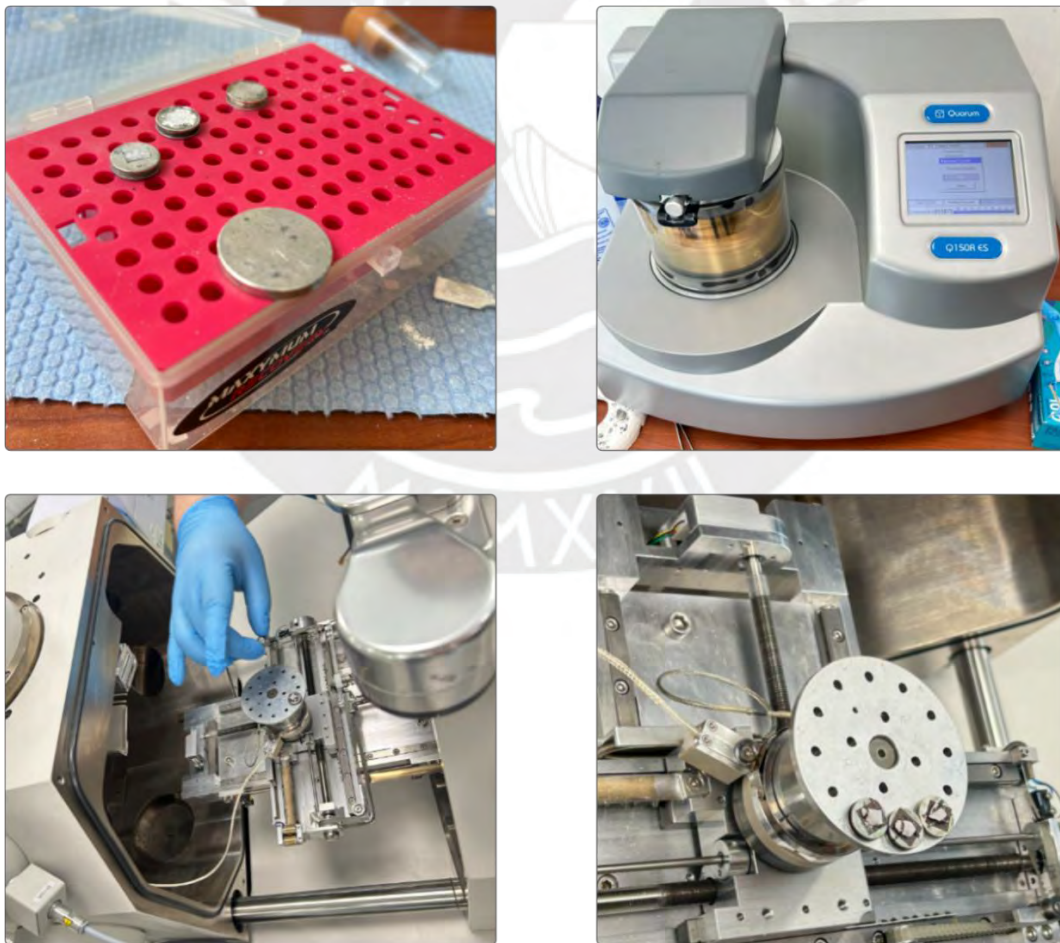
Figura 13. Preparación de muestras y análisis por microscopía SEM. Autoría propia.
