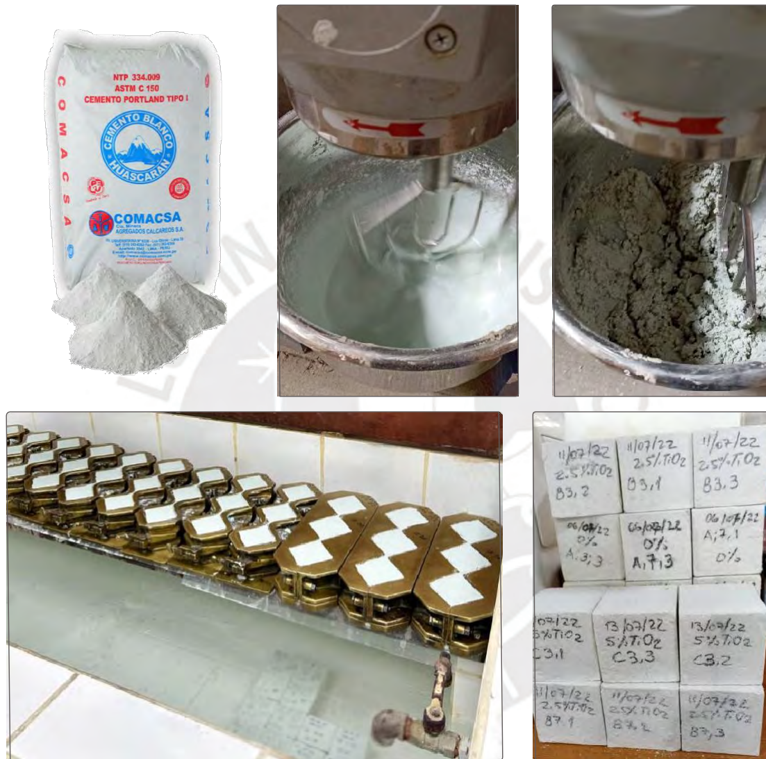
Figura 7. Proceso de preparación de cubos de mortero de cemento (Izquierda: mezcla en batidora, Centro: Cubos en moldes y en poza de curado, Derecha: Cubos finales). Autoría propia.
