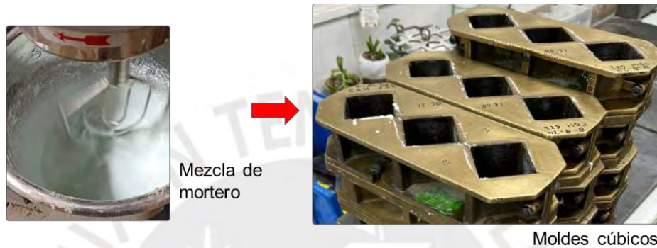
Figura 33. Proceso de adición de mezcla en moldes (Autoría propia)
