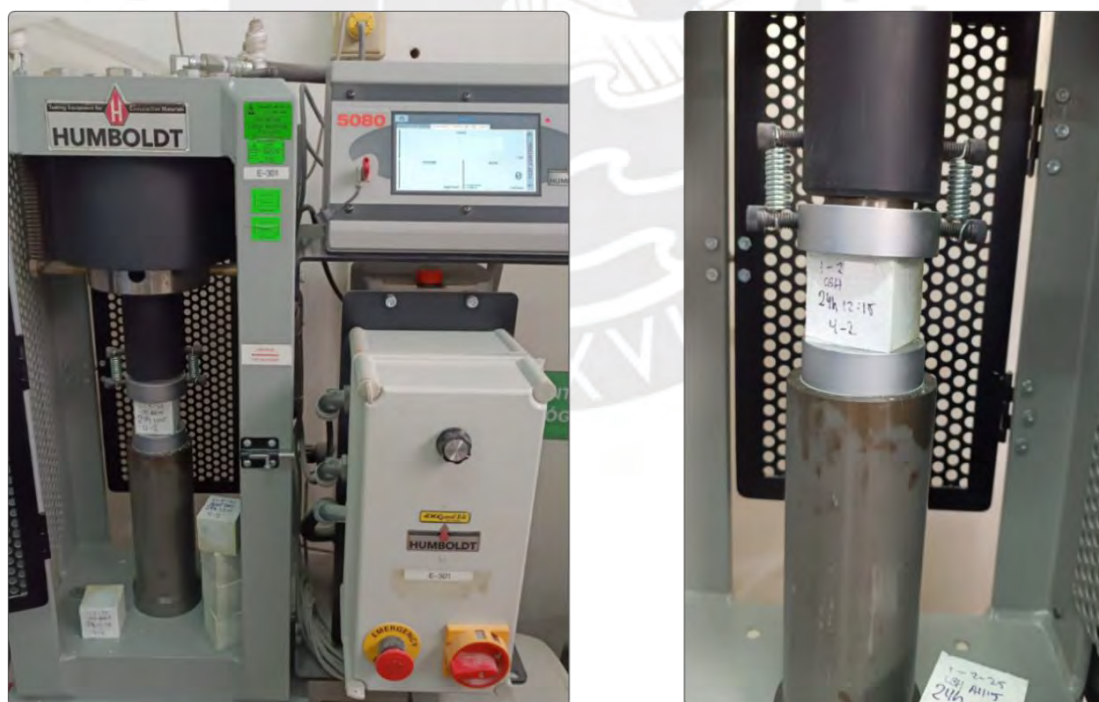
Figura 8. Prensa hidráulica utilizada para medir la resistencia a la compresión de las muestras de mortero. Autoría propia
