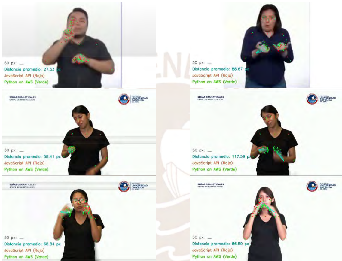
Figura 4.8: Divergencias entre modelos de estimación de pose disponibles desde Python y desde Javascript.
