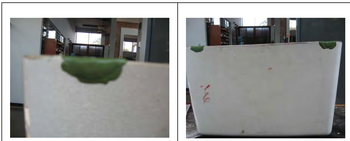
Fig. 3.7: Prototipo #1: Sellado de agujeros en tanque.
