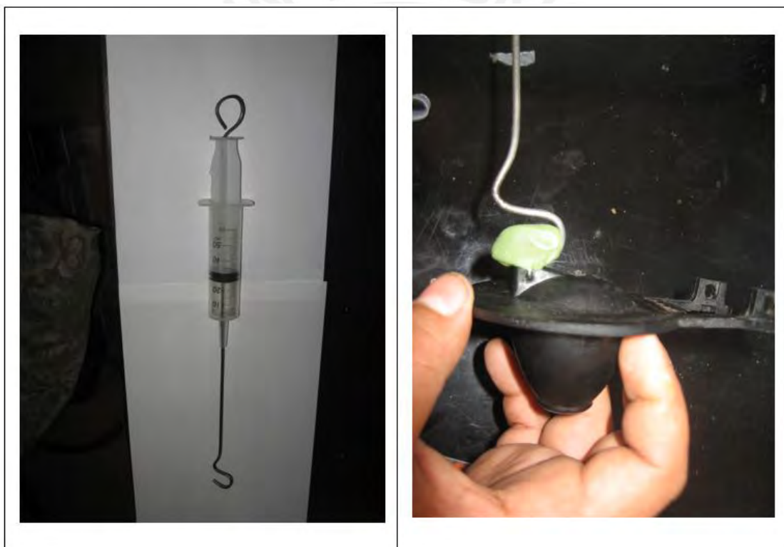
Fig. 2.8: Fotografías del mecanismo de accionamiento del sistema usado en el laboratorio.
