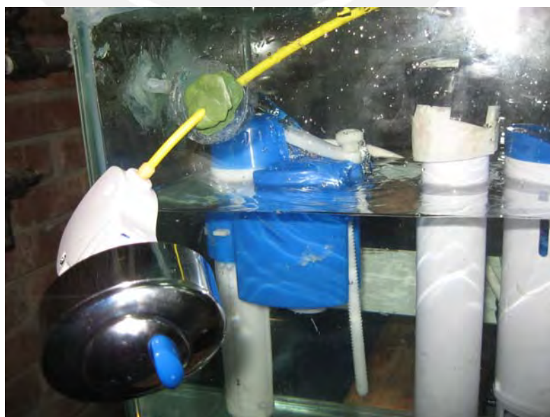
Fig. 3.16: Detalle del ingreso de la manguera neumática al tanque de vidrio.
