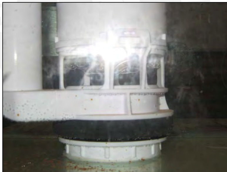
Fig. 3.35: Burbujas de aire presentes durante la descarga del sistema.
