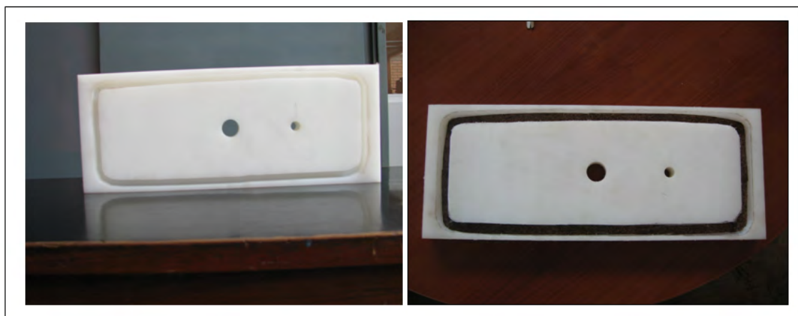
Fig. 2.6: Izq. Fotografía de la tapa utilizada en la experiencia del laboratorio. Der. Fotografía de la empaquetadura colocada en la tapa utilizada en la experiencia del laboratorio.
