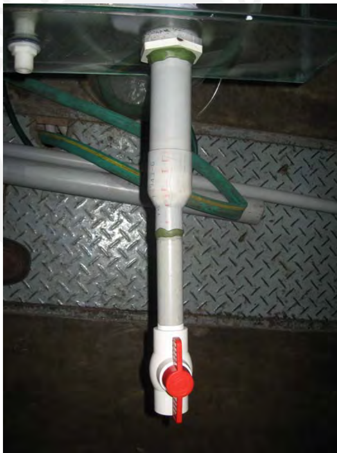
Fig. 3.14: Tubería, válvula y accesorios del sistema de descarga del tanque del Prototipo # 2.
