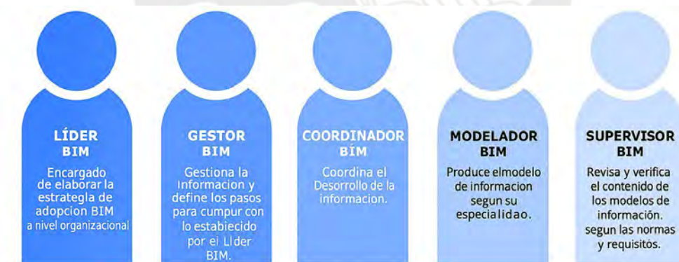
Figura 2. Roles y responsabilidades en la gestión de la información. Tomado de Guía Nacional BIM Perú.
