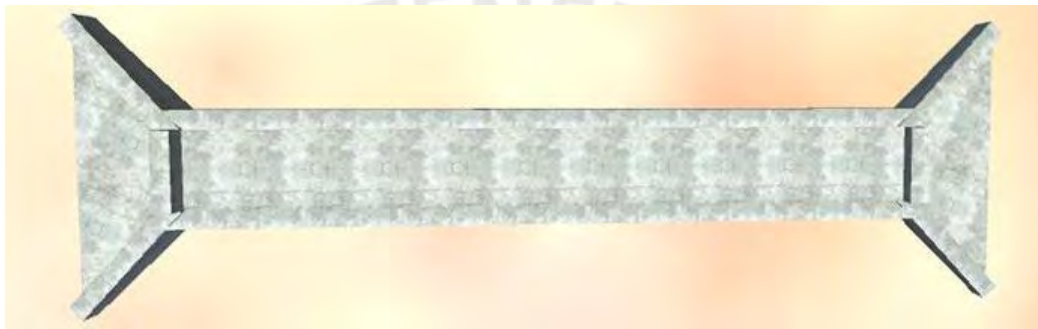
Figura 17. Modelado de la alcantarilla en Revit.
