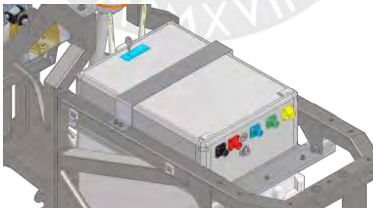
Figura 3.28. Montaje del Sistema de control (Infante Palacios, 2022)
