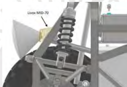
Figura 3.31. Posicionamiento sensor Lidar (Infante Palacios, 2022)
