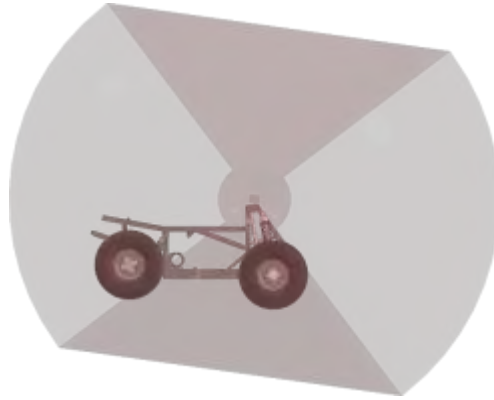
Figura 3.8. Lidar 360 montado en la parte superior
