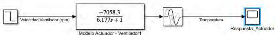
Figura 60. Modelo de Sintonización Ziegler Nichols para Actuator en Lazo Abierto
