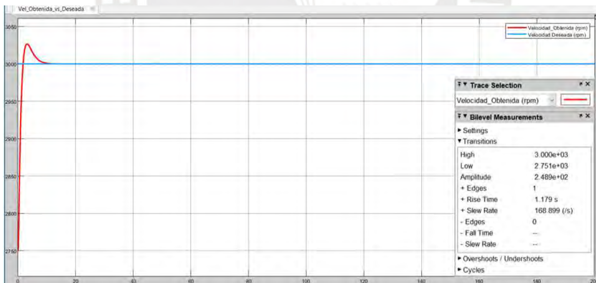
Figura 69. Simulación de Respuesta PID para Actuator en Modo Viajando Cargado
