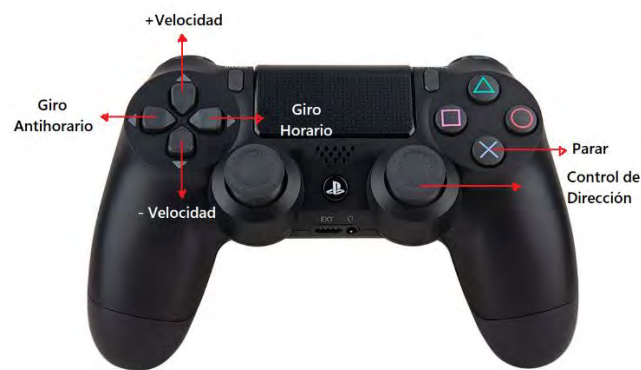
Figura 4. 32 Control PS4 Etiquetado
