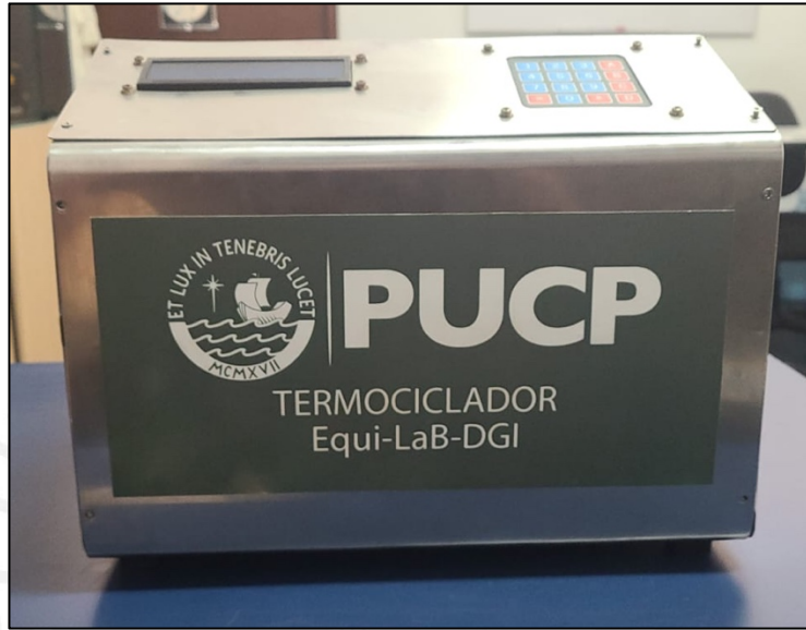
Figura 4.- Fotografía del tercer y actual prototipo de termociclador [21]
