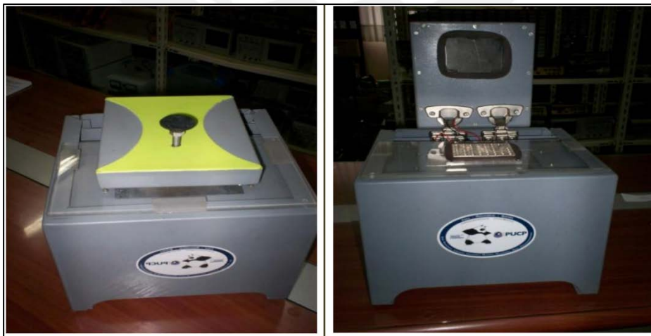
Figura 3.- Fotografía del segundo prototipo de termociclador abierto, a la derecha, y cerrado, a la izquierda, diseñado por Andía [20]
