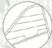
ADAPTACIÓN CON PLATAFORMAS Y TALUD
