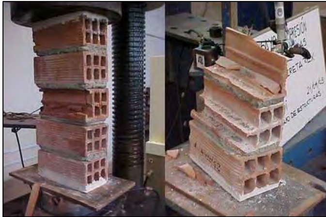
FIGURA 2- 20 Forma de falla de compresión en pilas de albañilería. Artesanal (izquierda) e industrial (derecha) (Fuente: Salinas et al, 2007)
