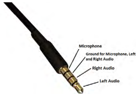
Figura 25. Esquema del conector Jack TRRS [20]
