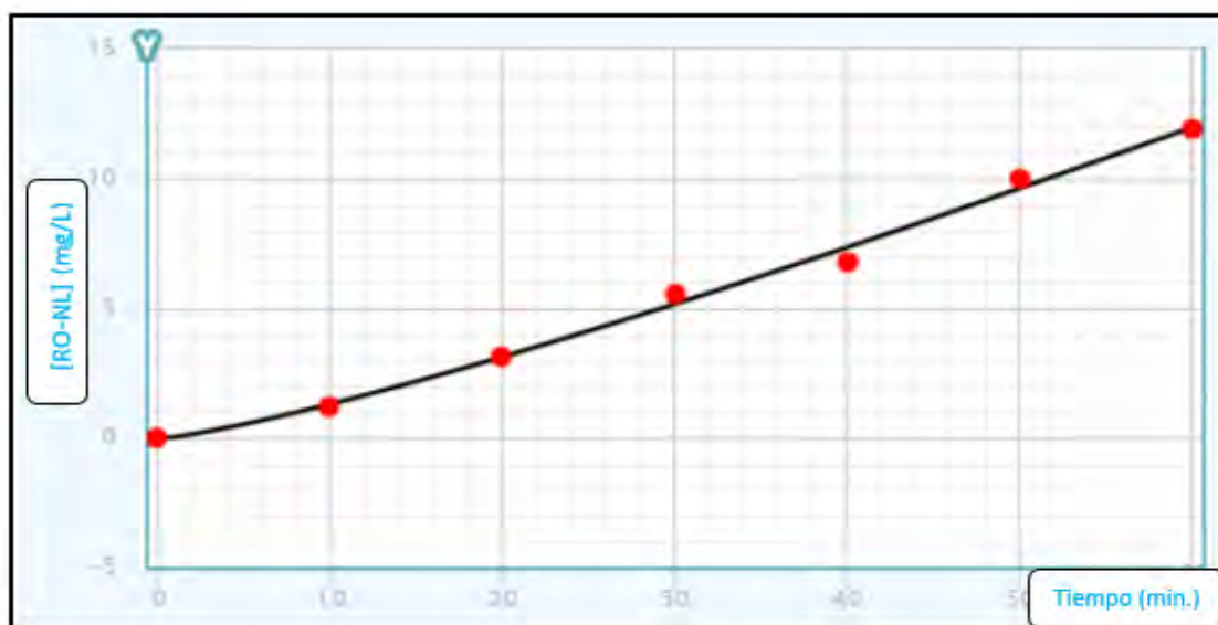
Figura 25. Estimación en función del tiempo, t(\text{min}) , del contenido de contaminantes oxidados (mg/L) mediante la ozonización.
