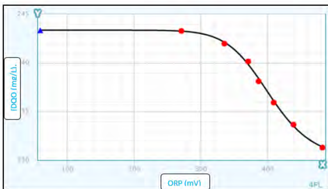
Figura 26. Estimación durante la ozonización de la demanda química de oxígeno, DQO (mg/L) respecto a los valores medidos de ORP(interno) (mV).
