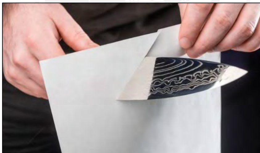
Figura 129: Prueba de verificación de filos de cuchillas Fuente: (Dreamstime, 2023)
