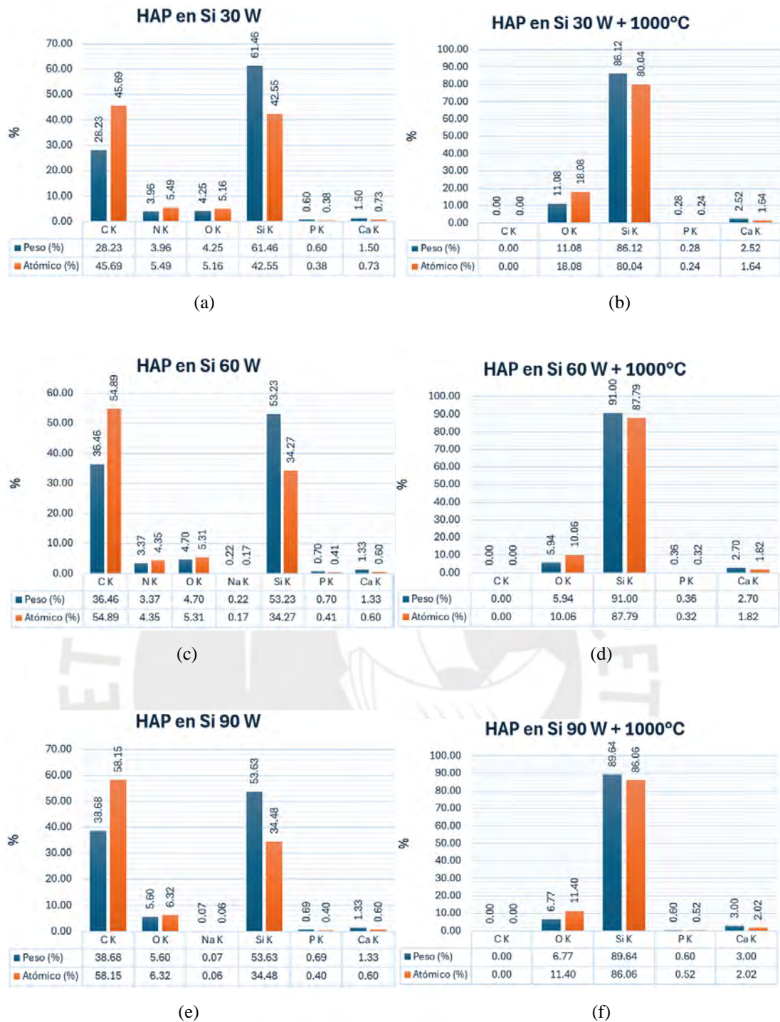
Figura 34: Grupo Experimental 2 - Resultados EDS de: (a) HAP en Si a 30 W, (b) HAP en Si a 30 W + 100°C, (c) HAP en Si a 60 W, (d) HAP en Si a 60 W + 100°C, (e) HAP en Si a 90 W, (f) HAP en Si a 90 W + 100°C
