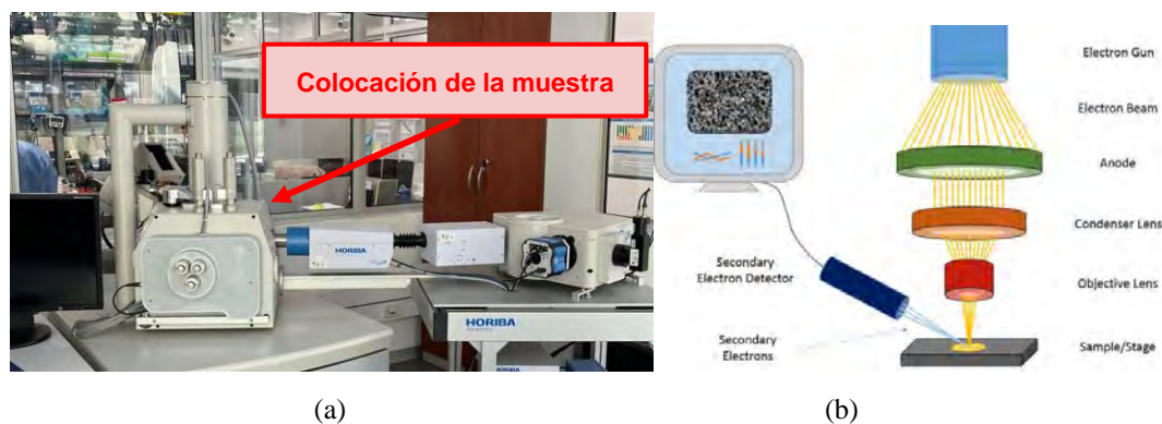
Figura 16: (a) Equipo de SEM QUANTA 650 integrado con equipo de EDS Edax Octane Pro, (b) principio de funcionamiento [40]
