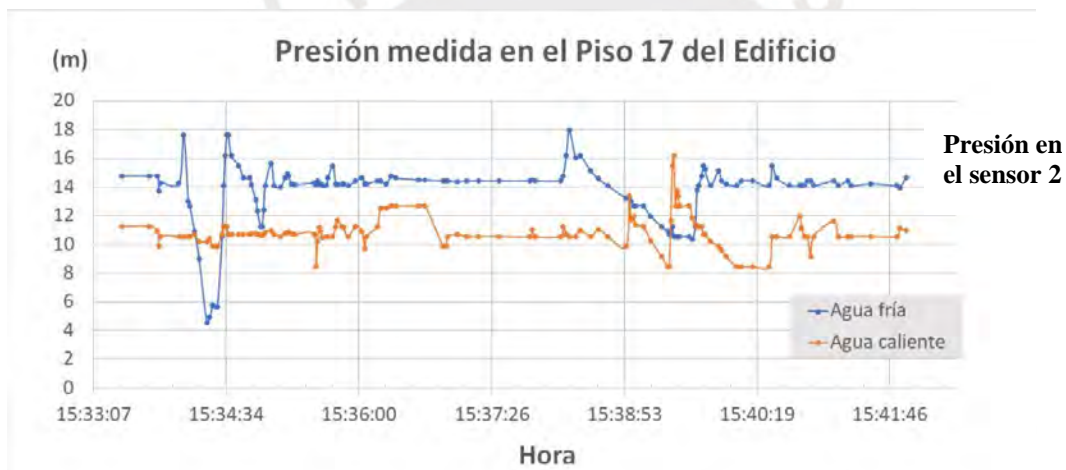
Figura 4.31b. Presión medida en el piso 17 del edificio.
