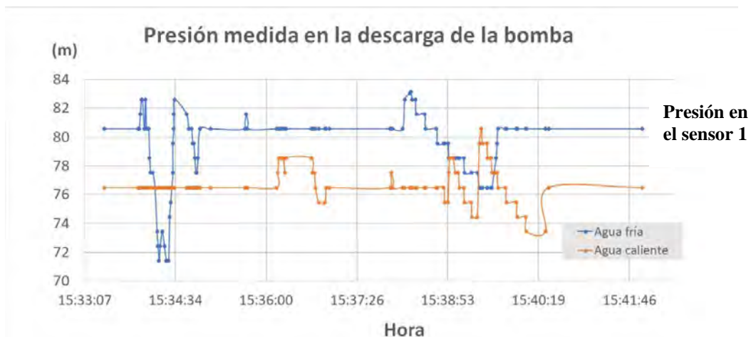
Figura 4.31a. Presión medida en la descarga de la bomba.
