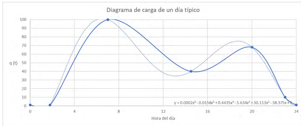
Figura 1.13. Diagrama de carga típico de consumo de agua en 1 día. Las unidades están en % con relación al caudal máximo de consumo.
