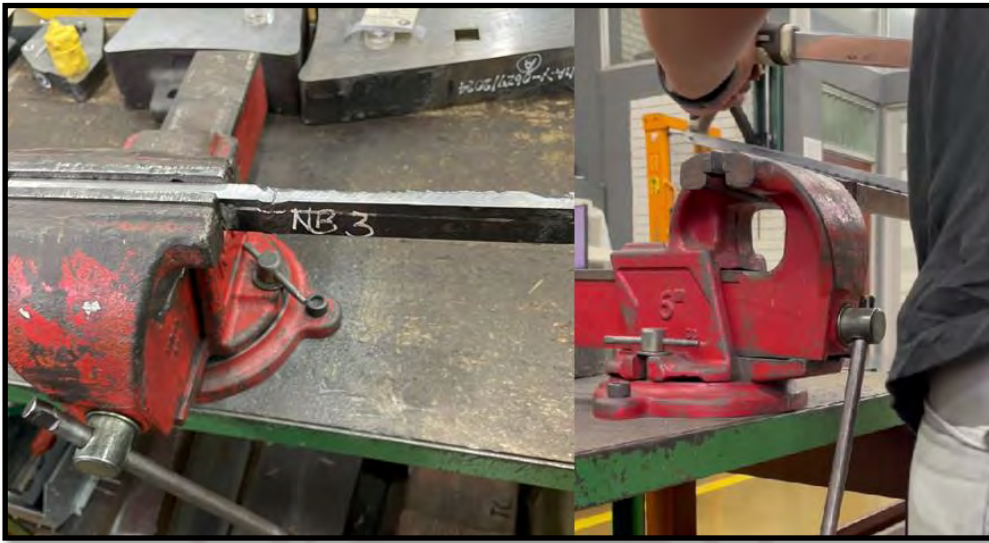
Figura 55. Preparación de probetas Nick Break Nota. Fuente propia.
