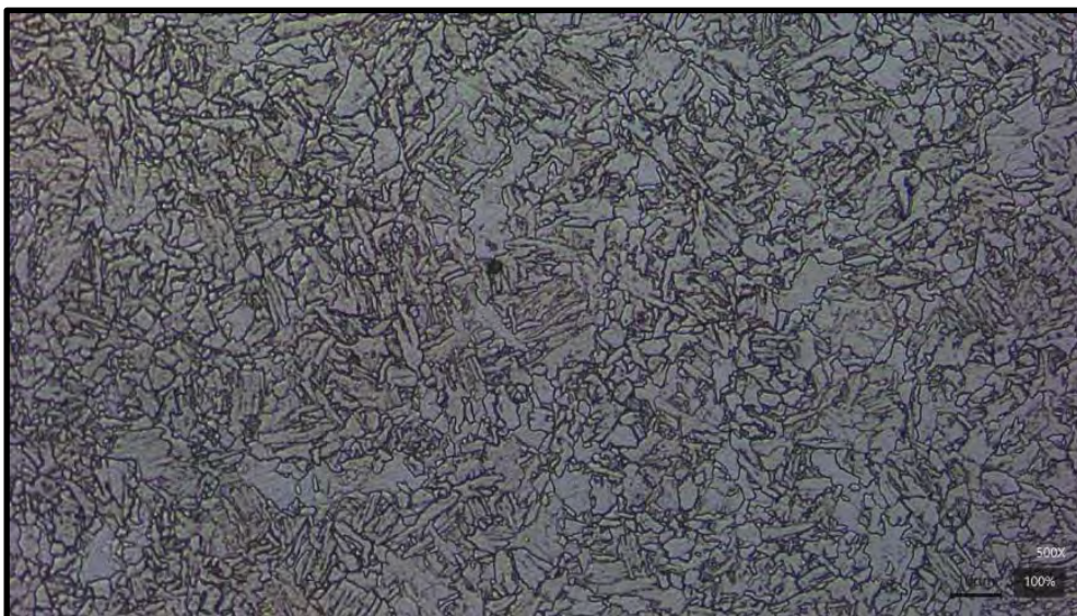
Figura 7. Metalografía del material base en aumento 500X con ataque Nital 2% Nota. Fuente propia.
