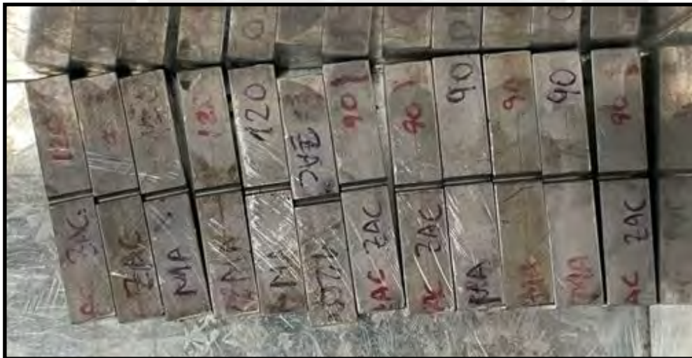
Figura 53. Probetas con entalla para ensayo de impacto Nota. Fuente propia
