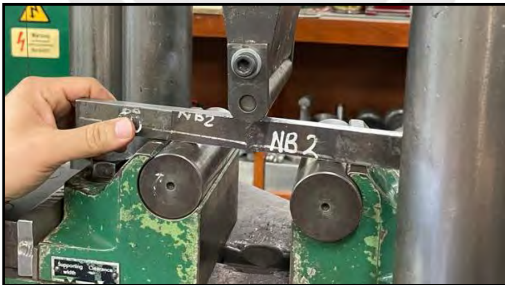
Figura 56. Ensayo Nick Break por API 1104 Nota. Fuente propia.
