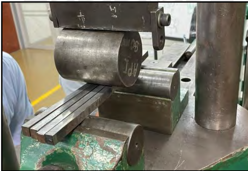
Figura 46. Ensayos de doblado API 1104 Nota. Fuente propia
