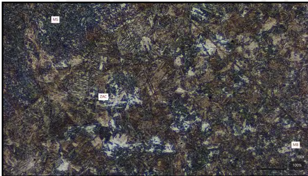
Figura 64. Microestructura a Tamb con aumento 100X Nota. Fuente propia.
