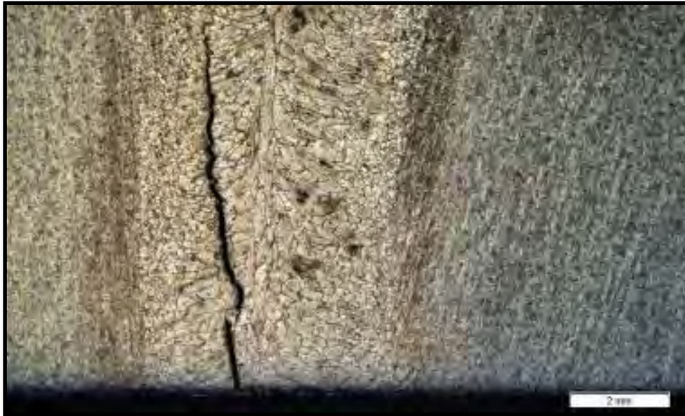
Figura 9. Fisuración en caliente Nota. Tomado de “Scielo”,2015.
