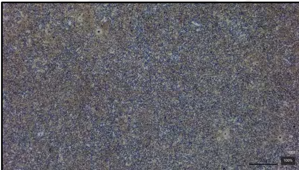
Figura 6. Metalografía del material base en aumento 100X con ataque Nital 2% Nota. Fuente propia
