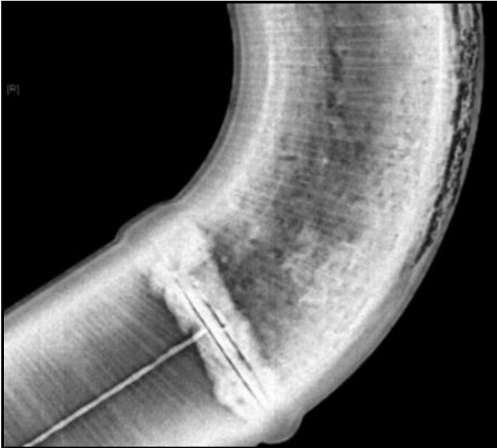
Figura 25. Ensayo de radiografía industrial Nota. Tomado de "ICOTSAC", 2021.
