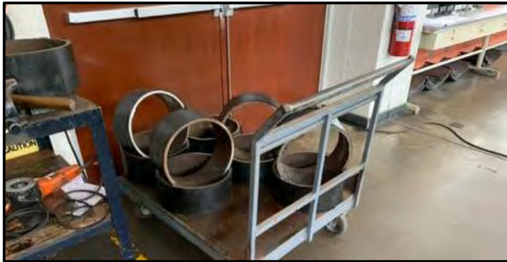
Figura 36. Retazos de tubería API 5L PSL2 X70M Nota. Fuente propia
