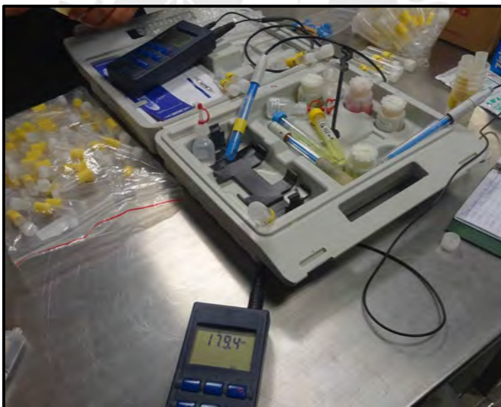
Figura 3-7: Medición de pH y Eh del agua de poros. Se realizó en recipientes de 7 ml, volumen mínimo necesario para cubrir el sensor.
