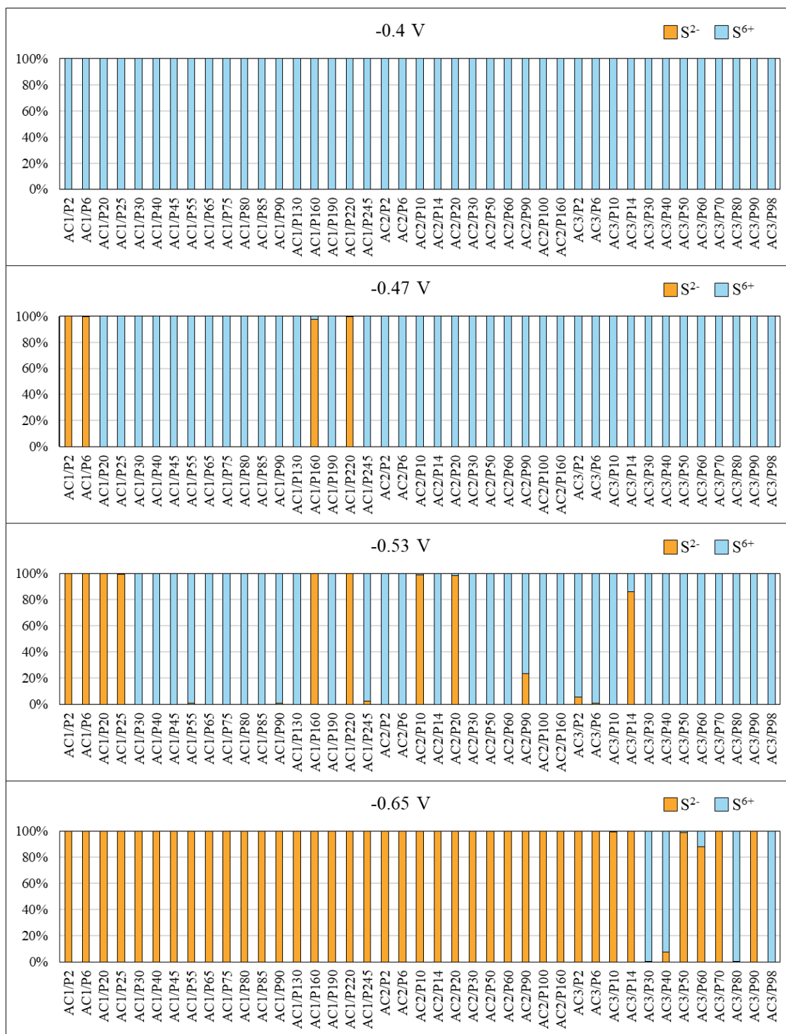
Figura 5-10: Abundancia relativa de los estados de oxidación del S ( S^{2-} y S^{6+} ) conforme se reduce el Eh (V) sin modificar la temperatura.
