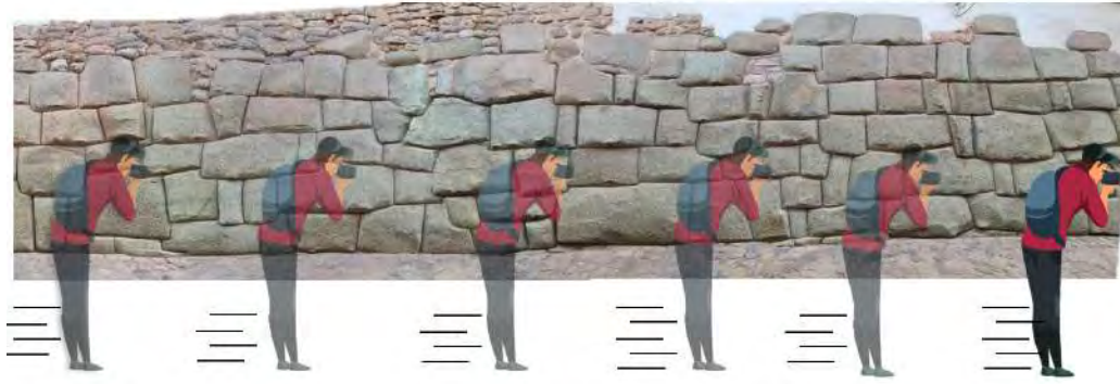
Figura 3-12: Toma de fotos en un muro de gran longitud
