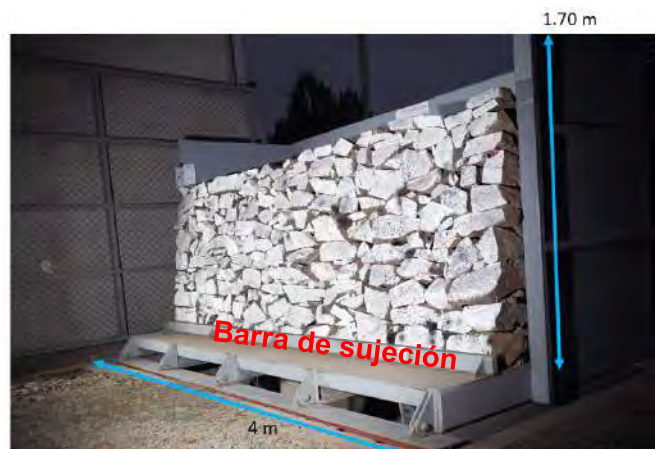
Figura 7-10: Plataforma para ensayos de volteo (Rivas, 2019)
