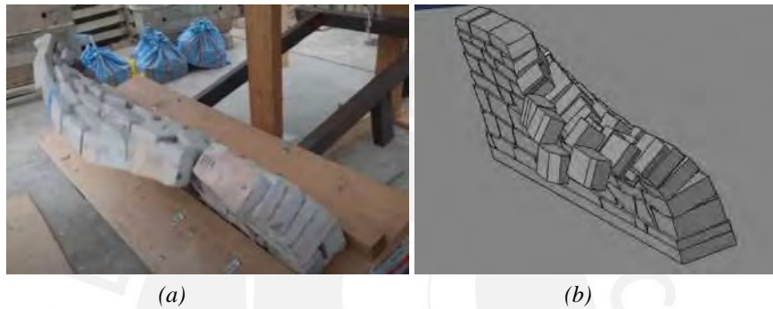
Figura 6-8: Colapso del muro a 14.3° de inclinación (a) Caso experimental (b) Modelo Numérico
