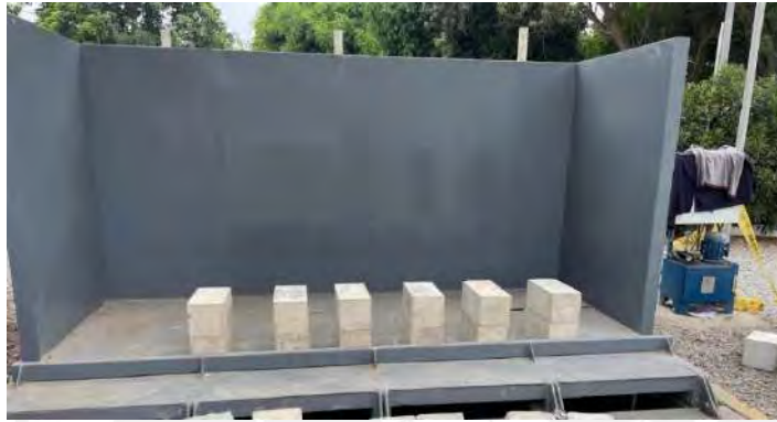
Figura 7-15: Ensayo de volteo en bloques
