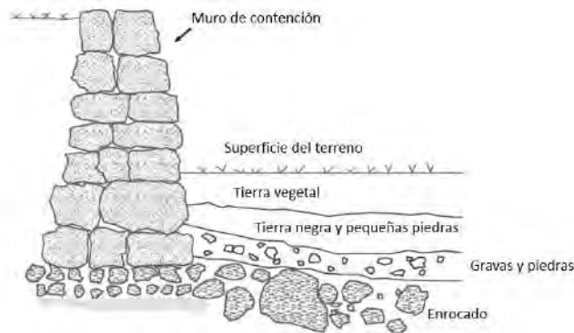
Figura 2-12: Estructura transversal de un andén de agricultura Editado de Wright (2011)
