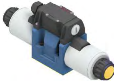
Figura 4.37: Vista isométrica de válvula direccional Rexroth de corredera 4/3, actuada por solenoides; con A, B y T conectados
