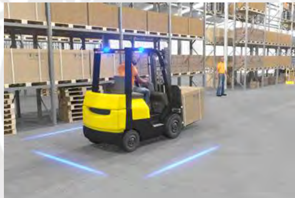
Figura 4.68: Luz de advertencia en perímetro de montacargas (RCT, s.f.)
