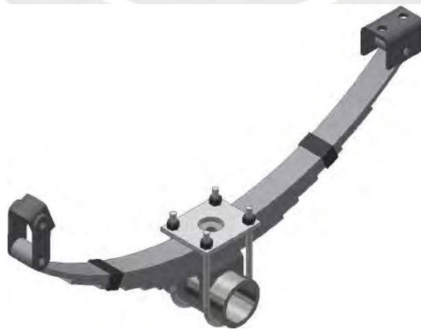
Figura 4.79: Sub ensamble de suspensión con ballestas
