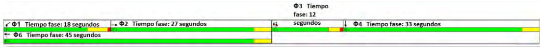
Figura 50: Distribución de fases en el tiempo semafórico para la propuesta de rediseño final Fuente: Captura propia del software Synchron
