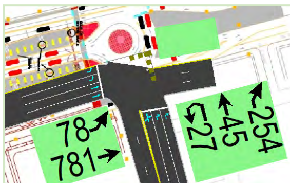
Figura 33: Pestaña mostrando la geometría de la intersección semaforizada del cruce de Chinchaysuyo y Tupac Amaru en el software Synchro Fuente: Captura propia del software Synchro
