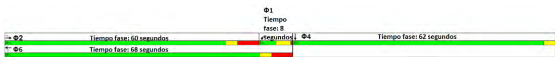
Figura 46: Distribución de fases en el tiempo semafórico para la propuesta de rediseño 1
