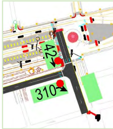
Figura 35: Pestaña mostrando la geometría de la intersección regulada por señal de pare del cruce de Chinchaysuyo y Contisuyo en el software Synchro Fuente: Captura propia del software Synchro
