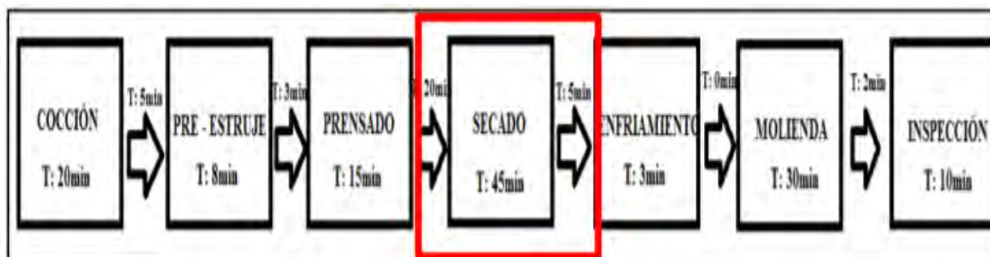
Figura 11 Proceso de elaboración de harina de pescado
