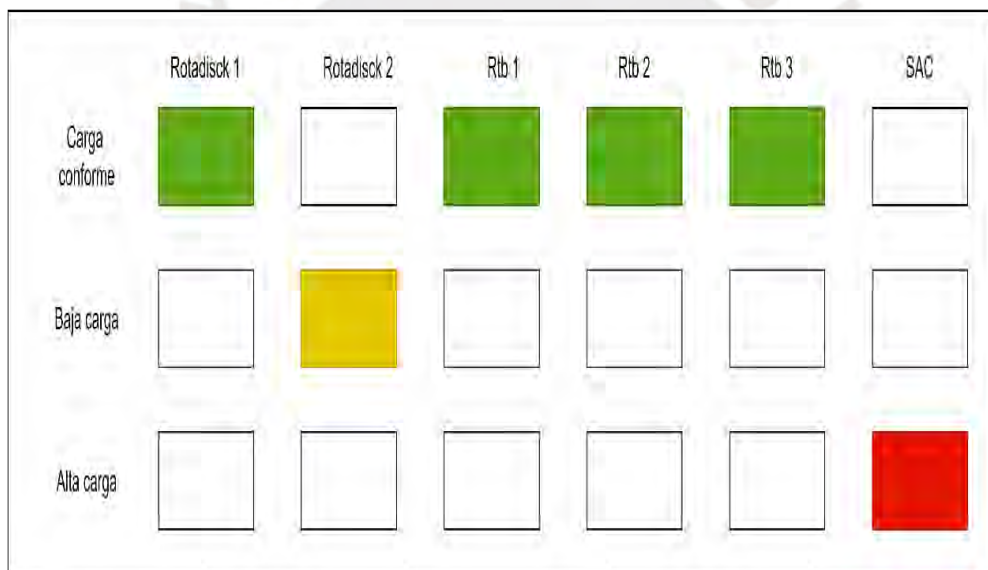
Figura 59 Tablero Andon para la etapa de secado
