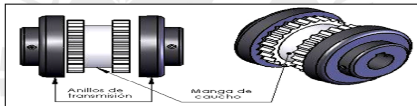
Figura 3.21: Acoplamiento flexible de la marca TB Wood’s.
