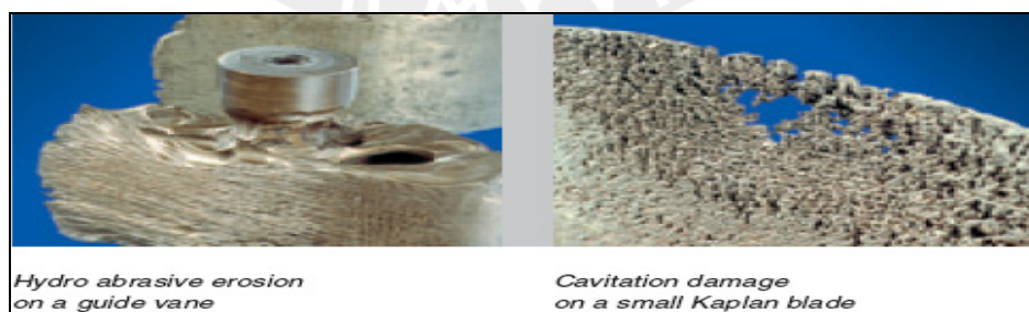
Figura 2.35: Cavitación y erosión en los álabes de la turbina axial.
