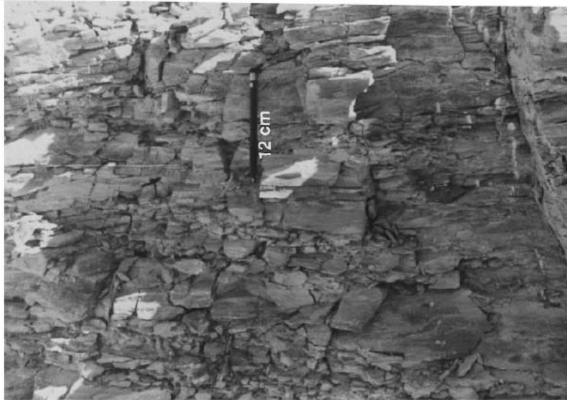
Figura 7-2: Vista del esquisto intensamente fracturado, se observan sistemas de discontinuidades estrechamente espaciadas y planos de esquistosidad (Sonmez y Ulusay, 1999)
