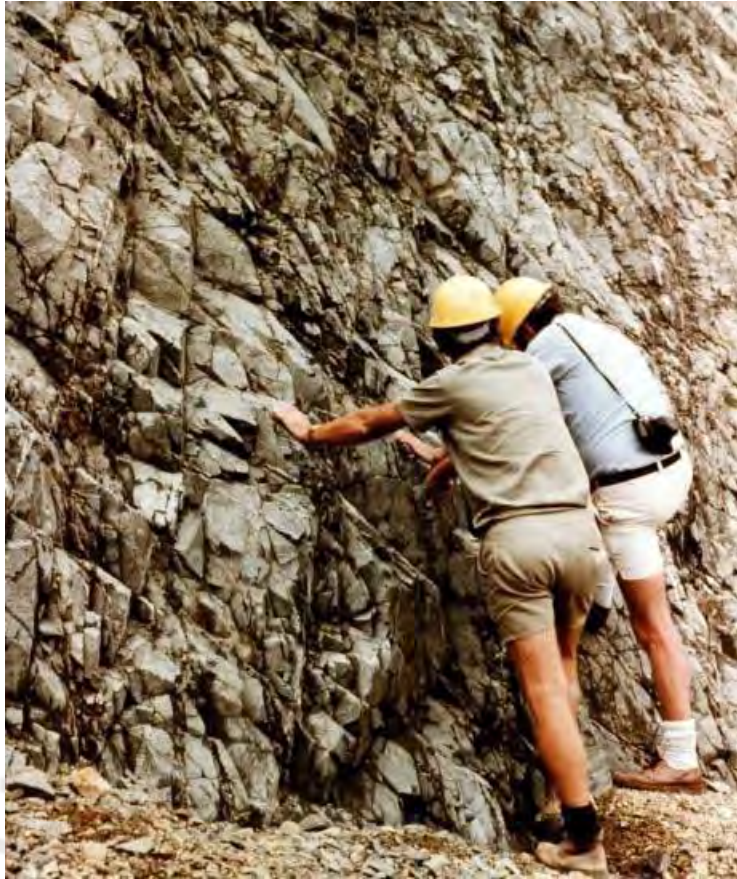
Figura 2-3: Bloques de roca muy duros e intertrabados de andesita y granodiorita en la mina Bougainville (Papua Nueva Guinea), para los cuales fue desarrollado el criterio de rotura original de Hoek-Brown (Hoek y Brown, 1980)
