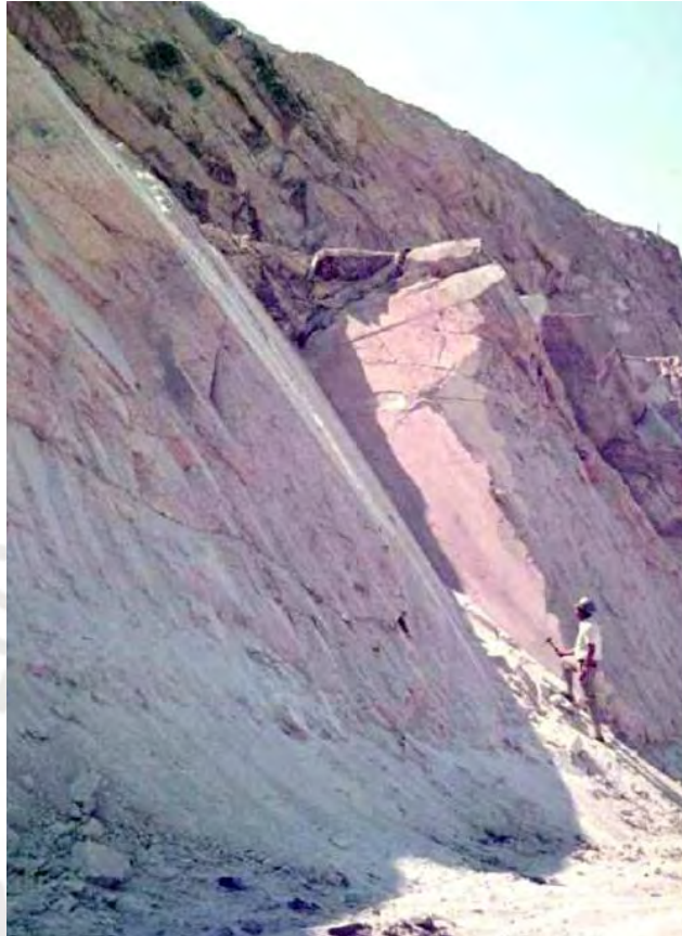
Figura 1-6: Ejemplo de rotura estructuralmente controlada (cuña) en los bancos de un tajo abierto (Hoek, 2009)
