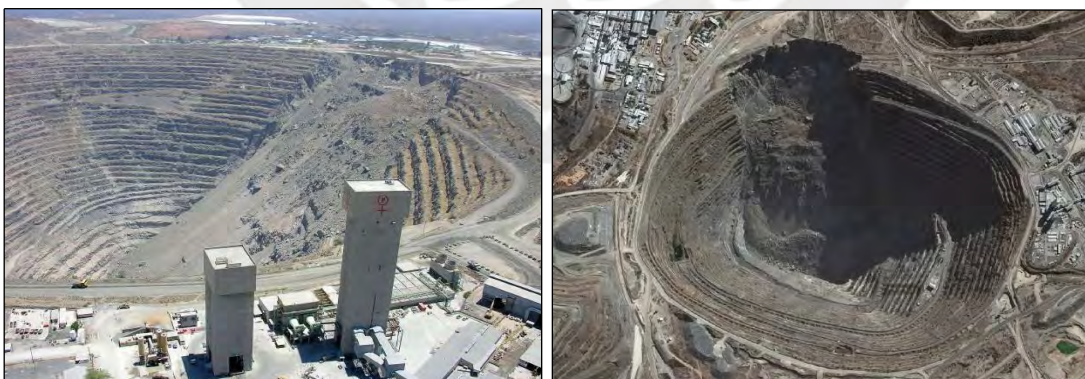
Figura 1.7: Rotura rotacional en un talud global de un tajo abierto (Rabus et al. , 2009)
