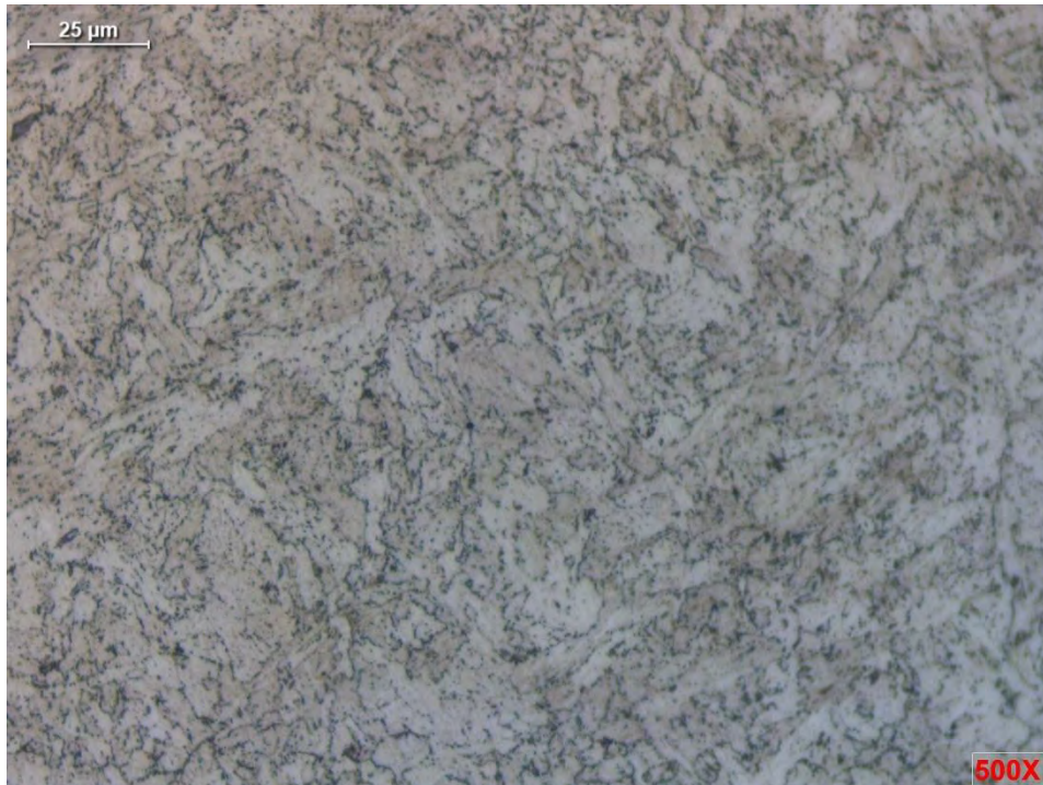
Figura 76. Metalografía del MA de P1. Muestra con ataque: Nital 5%. 500X.
