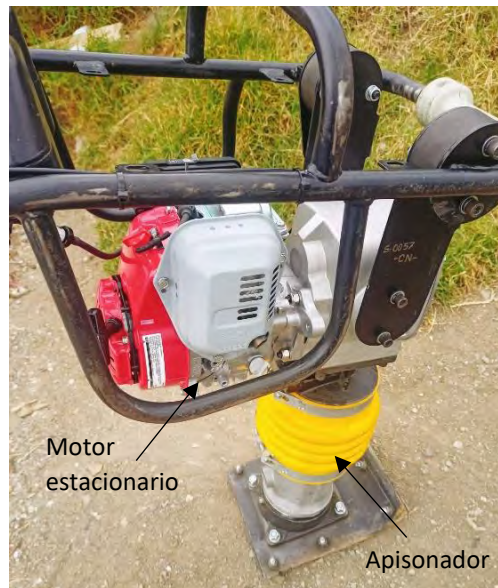
Figura 7. Motor acoplado a apisonador.
