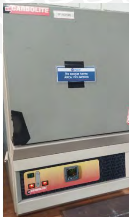
Figura 60. Horno utilizado para realizar los tratamientos térmicos.
