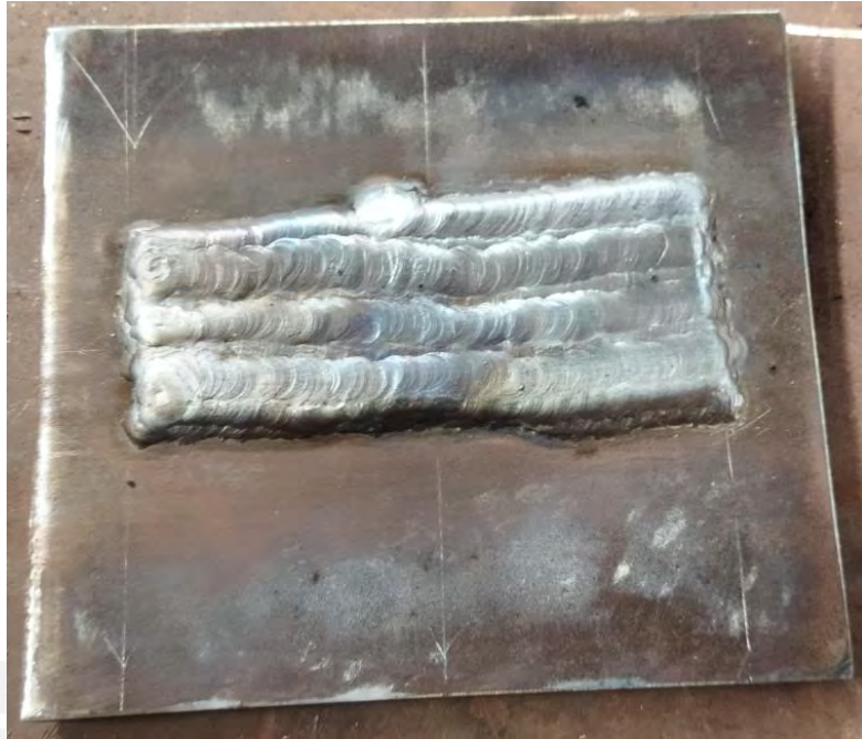
Figura 36. Placa de acero 1045 con revestimiento de soldadura.
