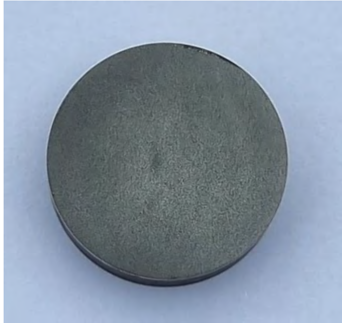
Figura 22. Sección de cigüeñal preparada para ensayo de dureza Vickers.
