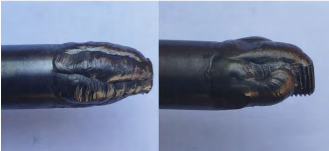
Figura 57. Cigüeñales con soldadura de revestimiento.
