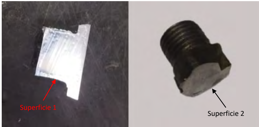
Figura 12. Superficies para análisis metalográfico.
