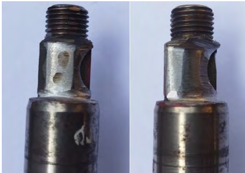
Figura 52. Superficie de cigüeñales preparada previo a ejecución de soldadura.
