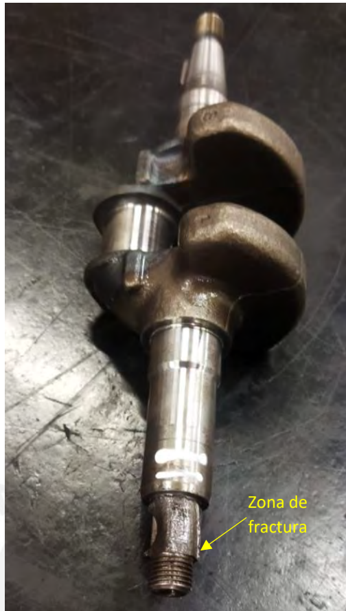
Figura 9. Cigüeñal fracturado extraído del motor.
