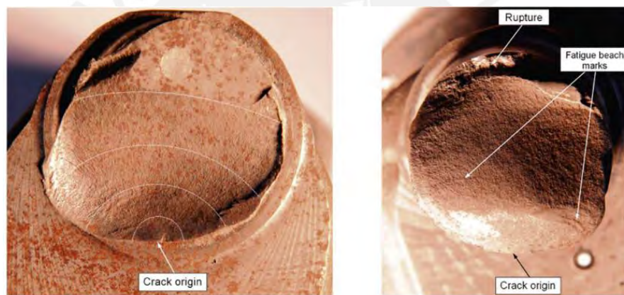
Figura 5. Zonas de origen de fisuras en cigüeñal (Witek et al., 2017).
