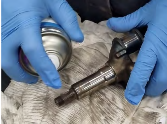
Figura 10. Limpieza de la superficie de fractura.
