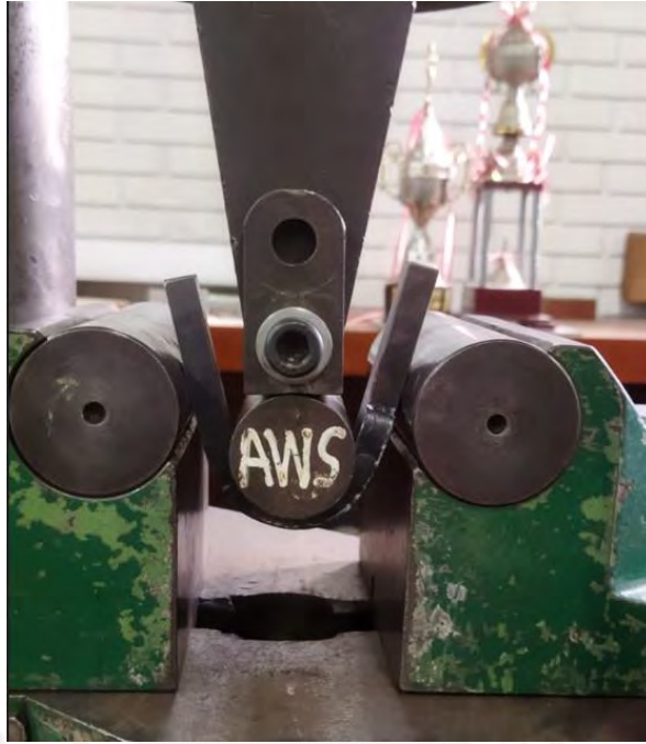
Figura 46. Probeta de soldadura durante ensayo de doblado.
