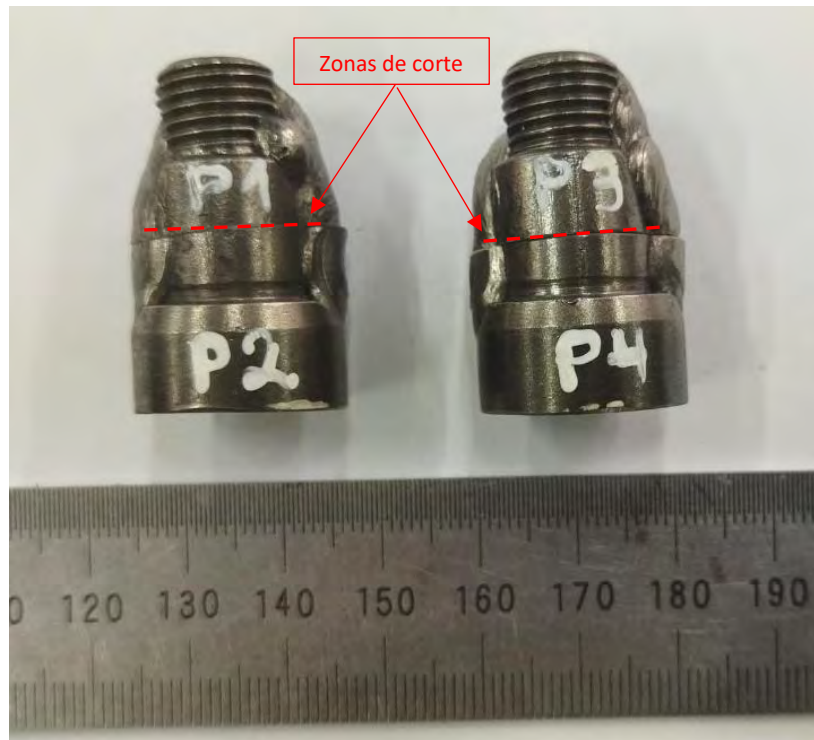
Figura 59. Muestras seccionadas para aplicación de PWHT.
