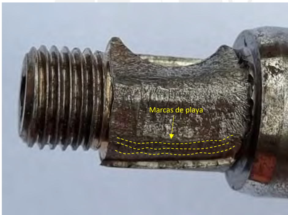
Figura 18. Marcas de playa en la superficie de fractura.
