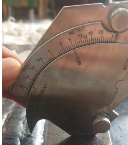
Figura 43. Verificación del espesor del revestimiento mediante galga de soldadura.
