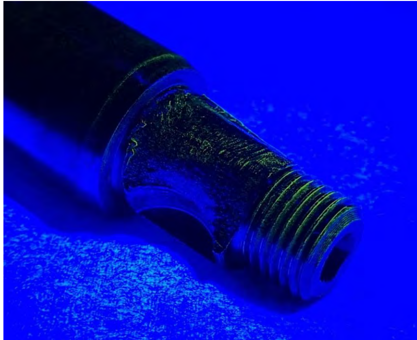
Figura 19. Resultado de aplicación de partículas magnéticas sobre la superficie de fractura.
