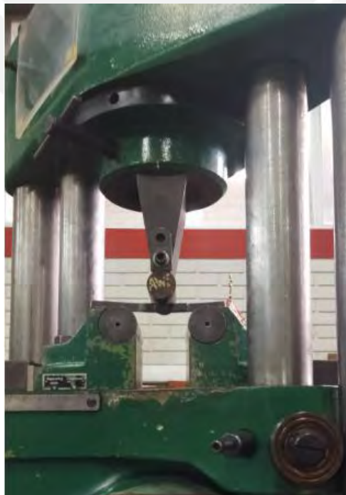
Figura 40. Máquina para ensayo de doblado.
