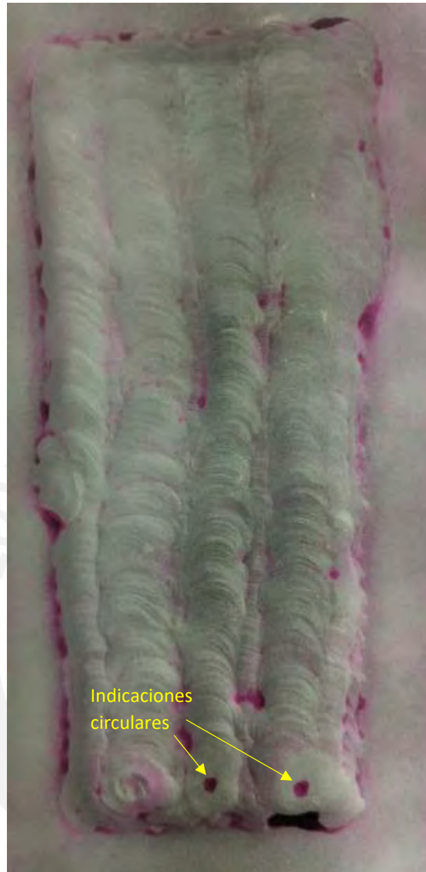
Figura 44. Superficie de soldadura ensayada con líquidos penetrantes.
