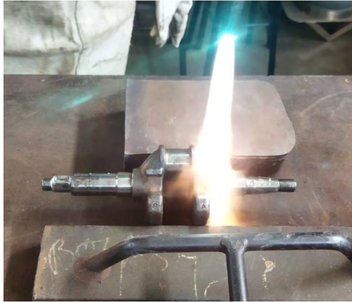
Figura 53. Pre calentamiento de cigüeñal mediante equipo oxiacetilénico.
