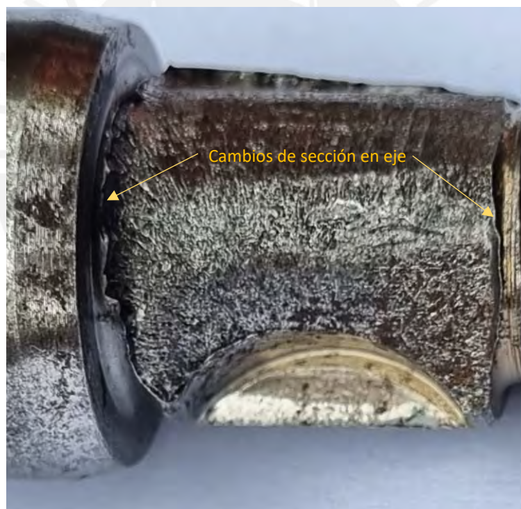
Figura 15. Límites de la zona de fractura.
