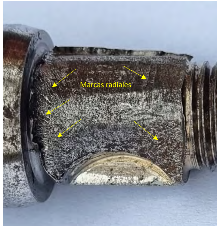
Figura 17. Marcas radiales que indican el sentido de propagación de la fractura.
