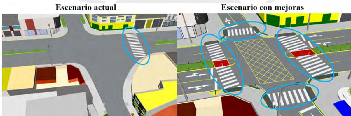
Figura 45. Cruceros peatonales de la intersección.
