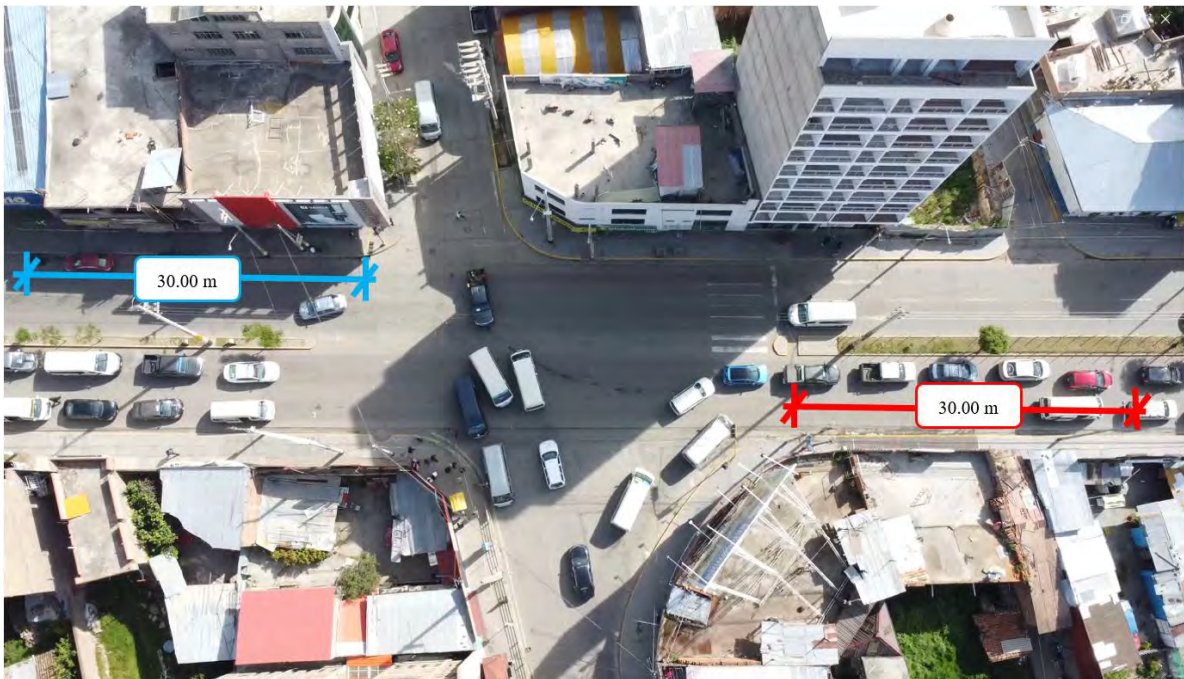
Figura 23. Tramos de evaluación para la obtención de la velocidad vehicular deseada.
