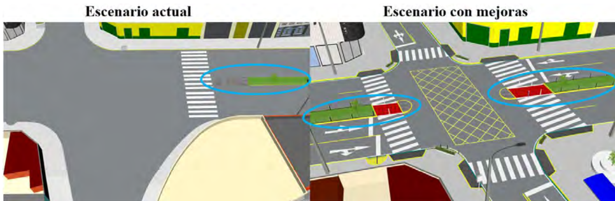
Figura 46. Mediana y área de refugio peatonal.
