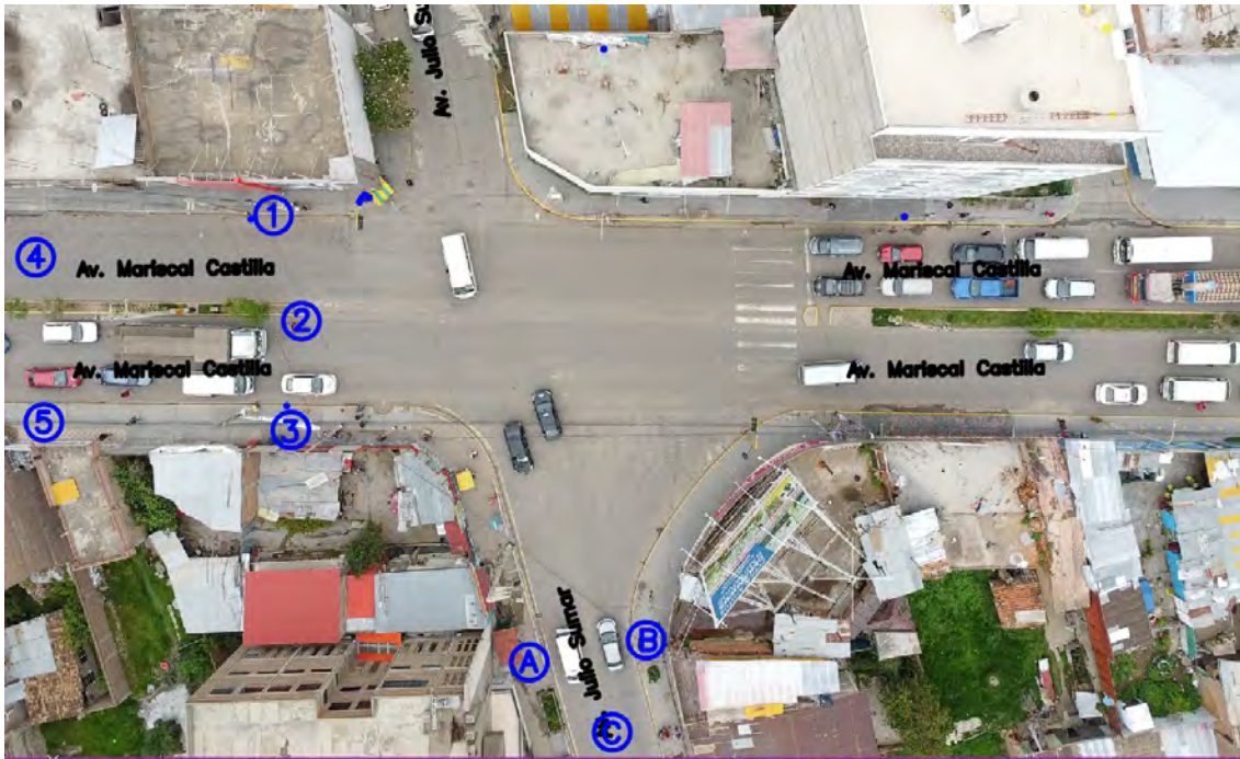
Figura 27. Ubicación de puntos de medición de los parámetros lumínicos en los accesos de la intersección.
