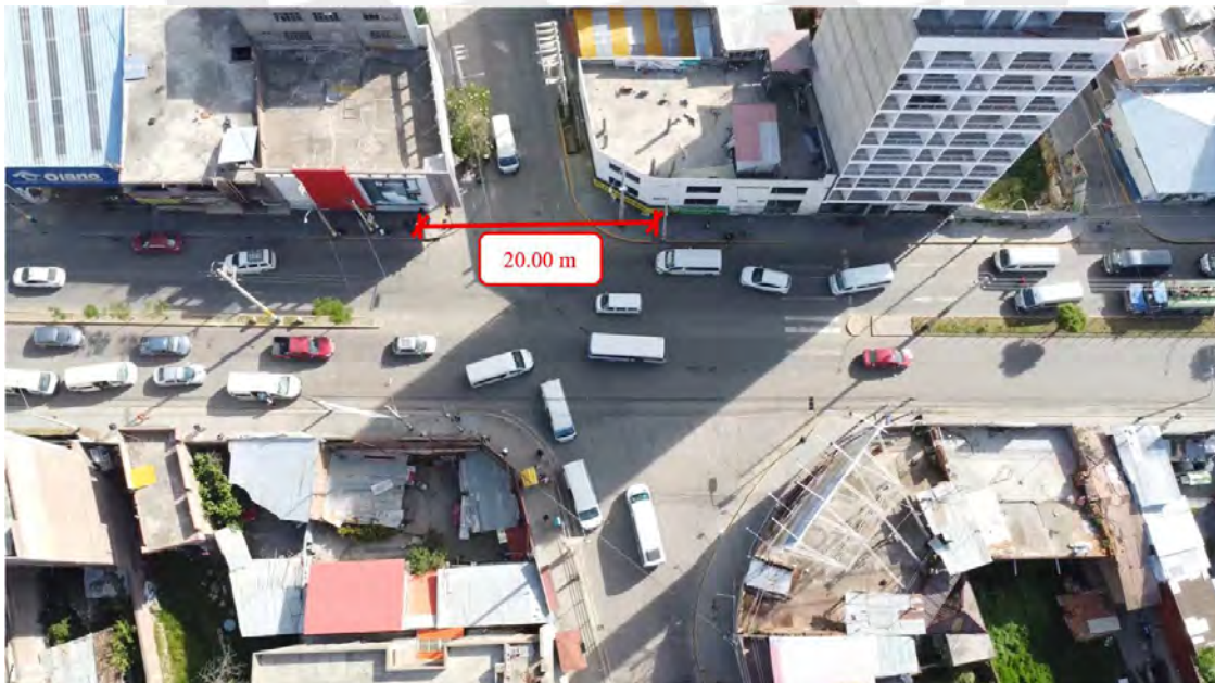
Figura 25. Tramo de evaluación para la obtención de las velocidades peatonales deseadas.
