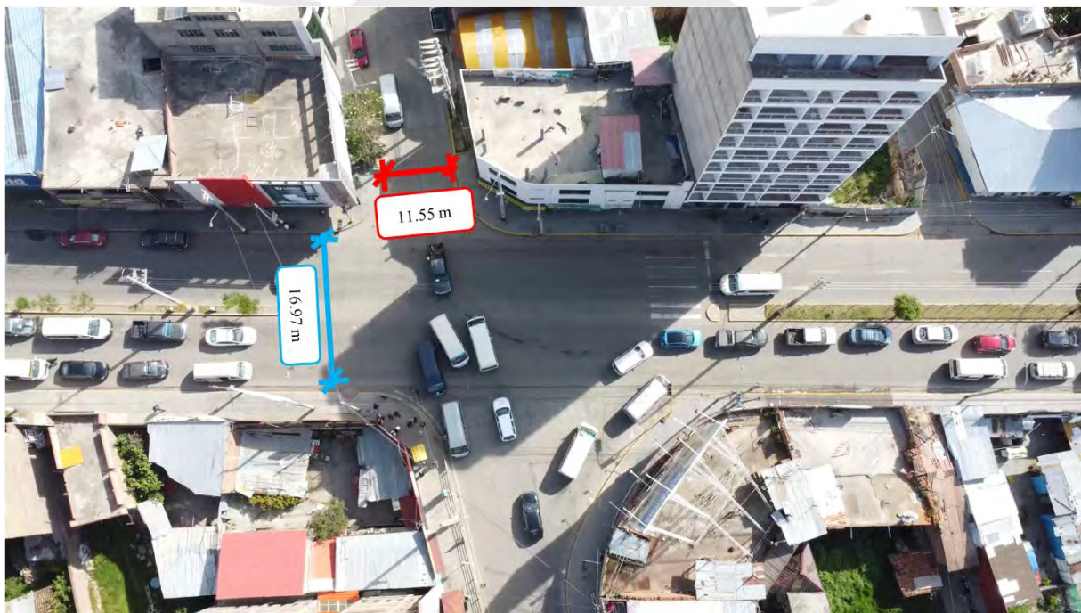
Figura 22. Tramo de medición de los tiempos de viaje peatonales en la intersección.
