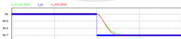
Figura 4.26 Comparación de estimación de frecuencia entre PLL (con filtro de segundo orden) y FLL
