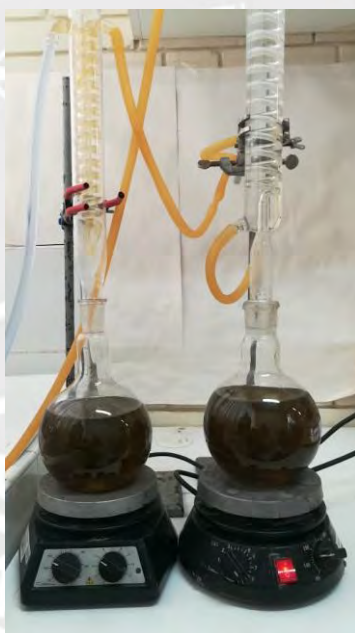
Figura 19. Imagen representativa del circuito de reflujo.
