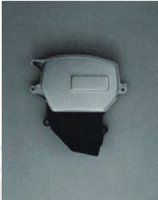
Figura 13. Timing belt cover hecho de a base de nylon 6 y nanoarcilla híbrida.
