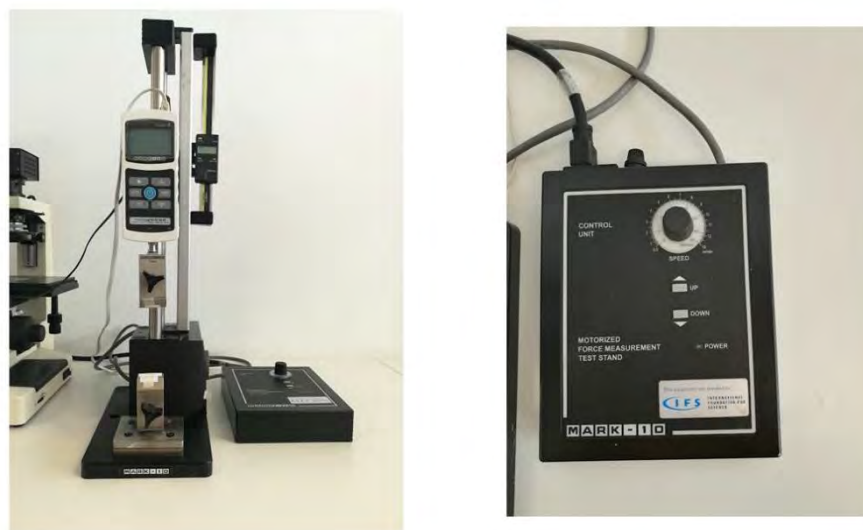
Figura 34. Máquina de ensayos a tracción Mark-10.
