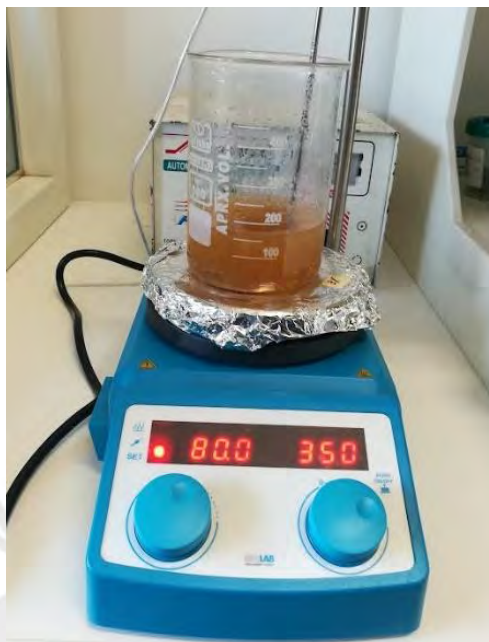
Figura 23. Disolución de 1g de exopolisacárido de N. commune en 100 mL de agua destilada a 350 rpm y 80°C en un agitador magnético.
