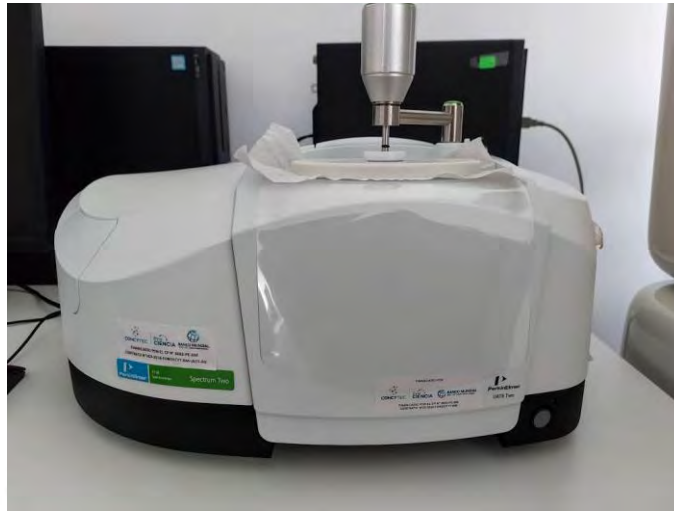
Figura 30. Espectrómetro FTIR Perkin Palmer modelo Spectrum Two con accesorio ATR.
