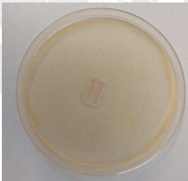
Figura 28. Film del nanocompuesto NC/MMT 7%.
