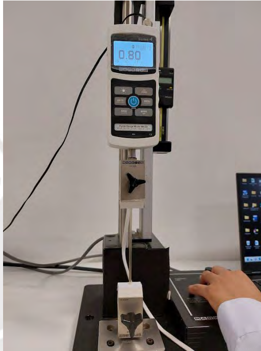
Figura 45. Muestra de NC/MMT sometida a tracción.
