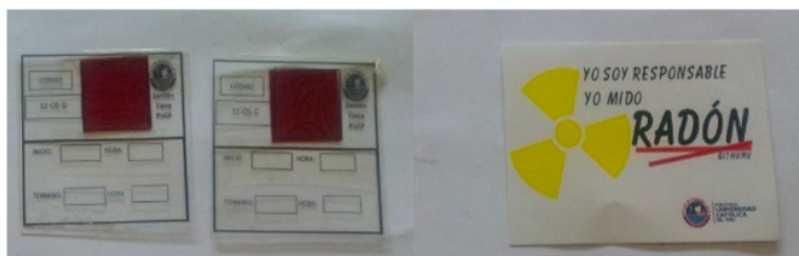
Figura 5.4. Detectores en modo desnudo utilizado en el monitoreo de radón en Lima-Perú y etiqueta recordatoria.
