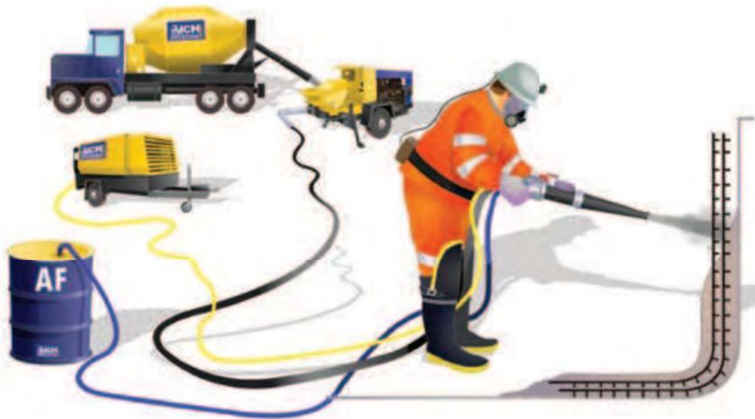
Figura 9: Equipo manual para el shotcrete por vía húmeda.
