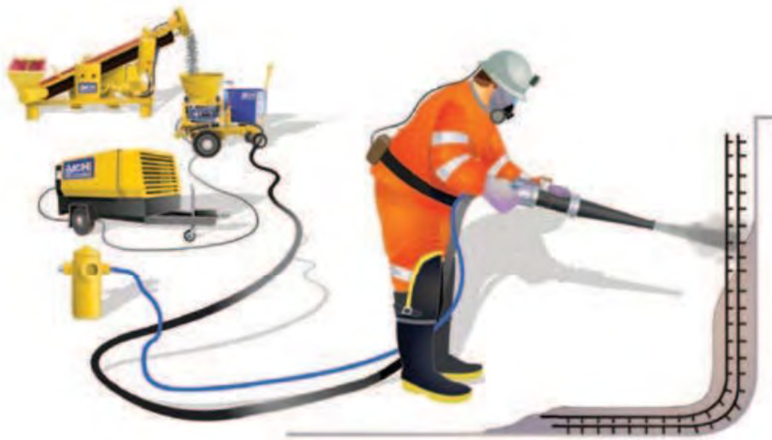
Figura 5: Equipo manual para el shotcrete por vía seca.
