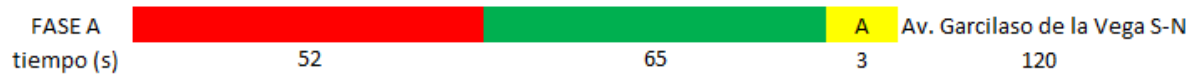
Figura 74 Ciclo semafórico de la intersección Av. Garcilaso de la Vega y Av. Bolivia
