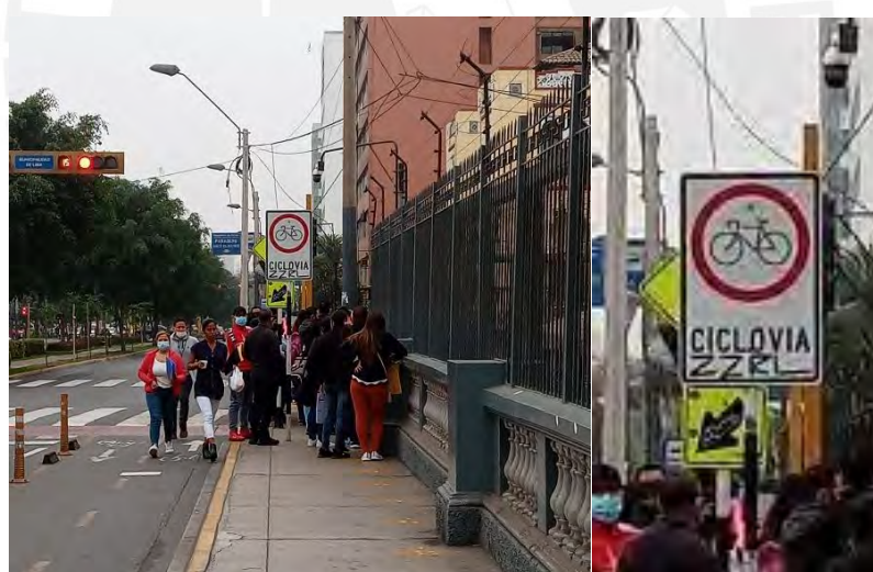
Figura 26 Señales visualmente superpuestas en la intersección con Jr. Manuel Corpancho
