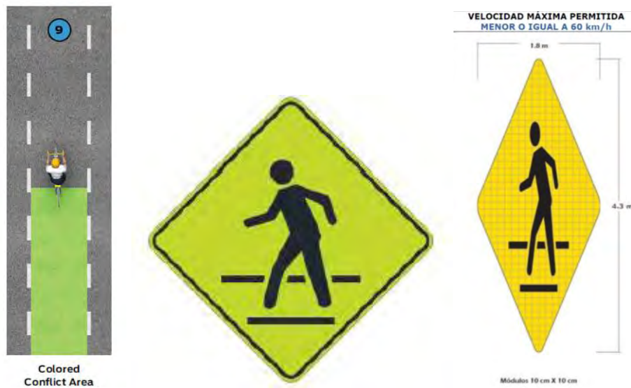
Figura 68 De izquierda a derecha. Zona de conflicto coloreada, señal vertical P-40A y señal horizontal P-40.
