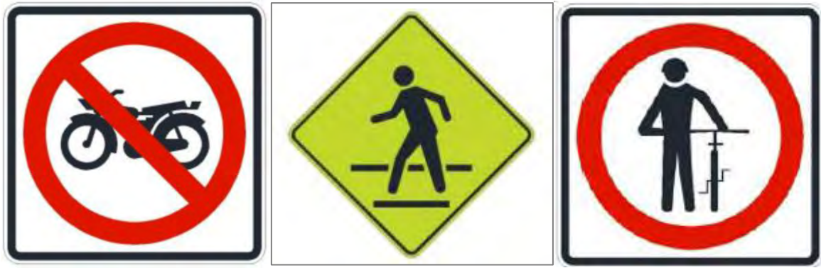
Figura 51 Señal “Prohibido circulación de motocicletas”, Señal “Proximidad de cruce peatonal” y Señal “Obligatorio descender de la bicicleta”
