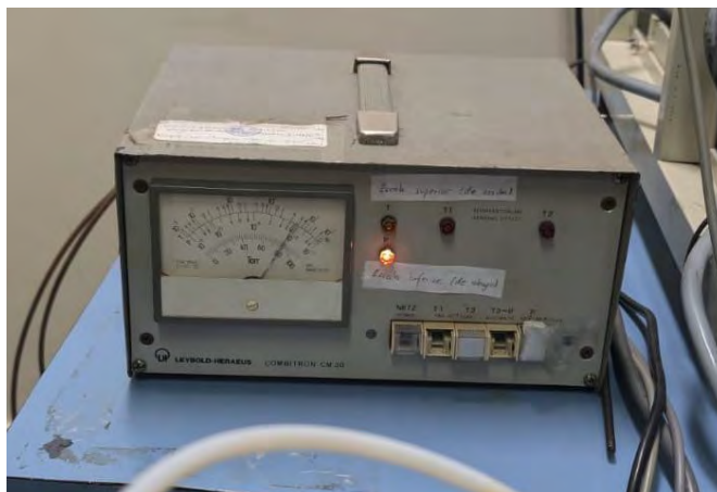
Figure 3-3 Lectura del vacuómetro durante el tratamiento con plasma, indicando una presión de trabajo aproximada de 5 \times 10^{-2} mbar.
