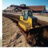
El control de pendiente de carga automática (Auto Grade) es una función que permite al operador trabajar en una pendiente de 2 a 1.
