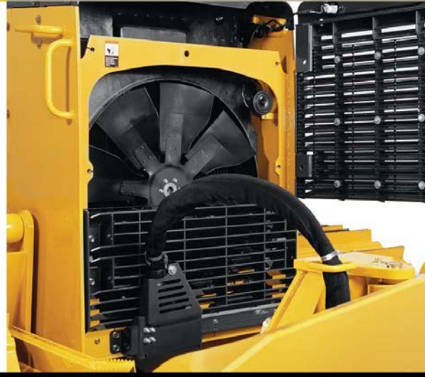
Este tractor con un ángulo no nivelado en el motor. Los rieles colocados hacia abajo con espacio amplio entre sus dedos reducen las vibraciones y el ruido de trabajo.
