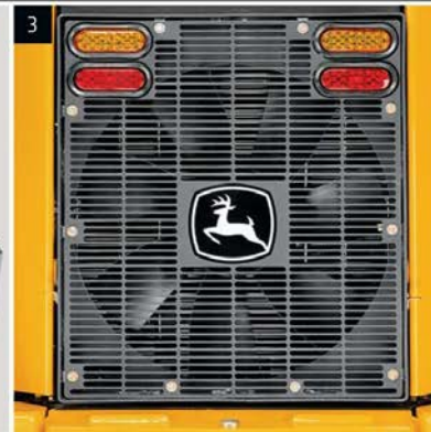
3. La rotación del ventilador programable opcional se invierte automáticamente en intervalos predefinidos, para expulsar la basura del radiador y del núcleo del enfriador. O bien elija sus propios ciclos de limpieza a través del monitor.
