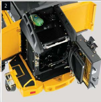
2. Quad-Cool coloca el radiador, el condensador de aire acondicionado, el interenfriador, el sistema hidráulico y de transmisión y los enfriadores de ejes opcionales en una configuración en caja única aislada del calor del motor. Para lograr una mayor eficiencia y durabilidad.
