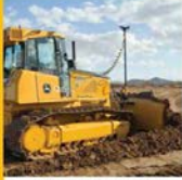
Con el control de pendiente (Incontrol) (S2) opcional, la acción de su sistema de control de pendiente garantiza un nivel como "saber pisar".
