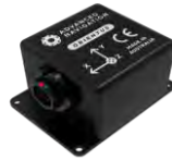
Figura 5.5 Sensor Orientus Fuente: (Advancednavigation)
