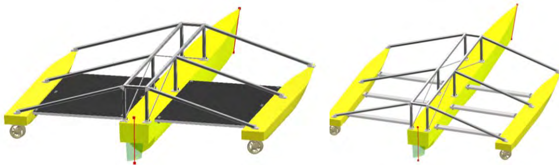
Figura 4.54 Estructura de paneles sobre cascos
