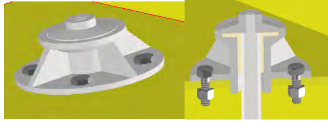
Figura 4.23 Sección de modelado de soporte superior acoplado
