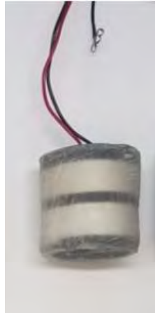
Figura 6.5 Hidrófono de 2 cilindros acoplados en serie Fuente: (Schinault, 2020)
