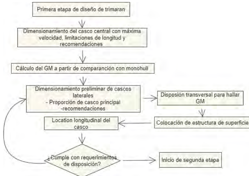
Figura 4.1 Primera etapa de diseño de trimaran
