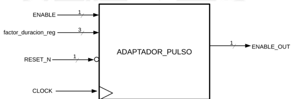
Figura 3.11: Entradas y salidas del bloque adaptador de pulso
