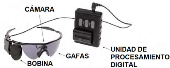
Figura 1.5: Componentes extraoculares de Argus II [9].
