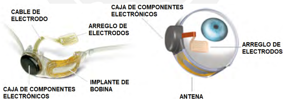
Figura 1.4: Componentes intraoculares de Argus II [9]
