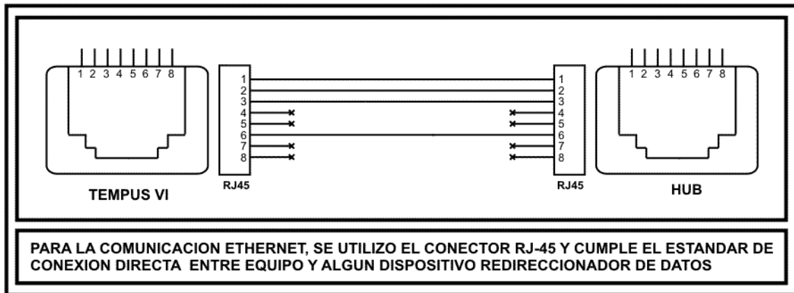
Figura 3.31 – Conexión a red: EQUIPO – HUB
