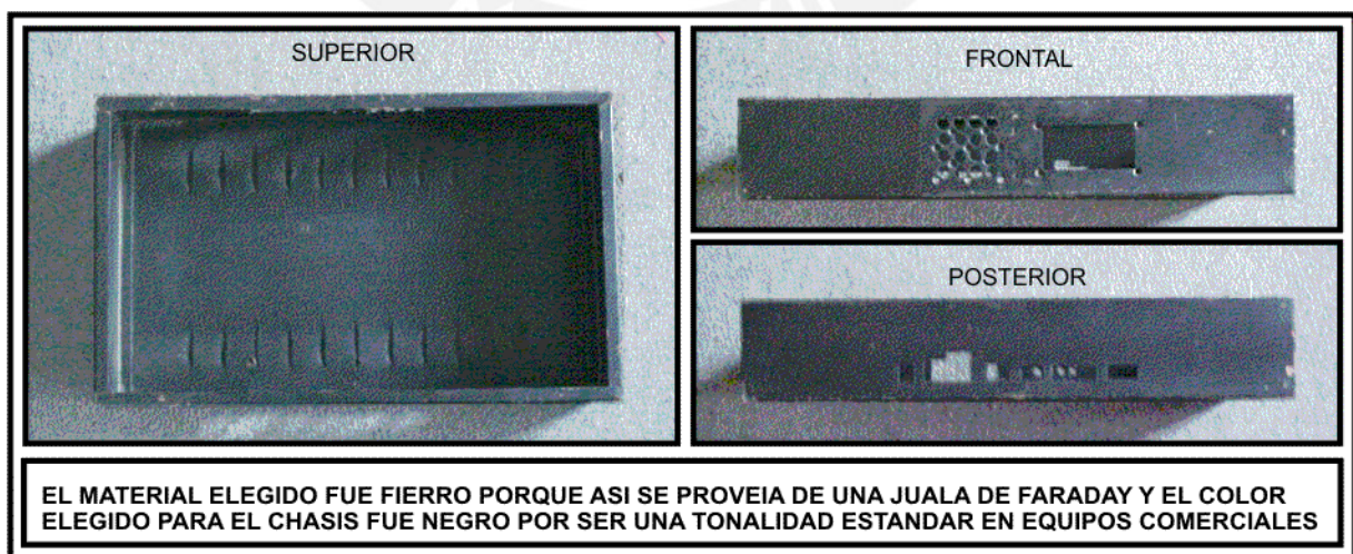
Figura 3.41 – Vista superior, frontal y posterior del chasis
