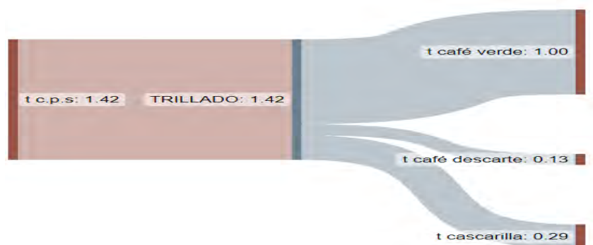
Figura 22. Entradas y salidas del proceso de trillado Nota: Elaborado con la página web www.sankeymatic.com
