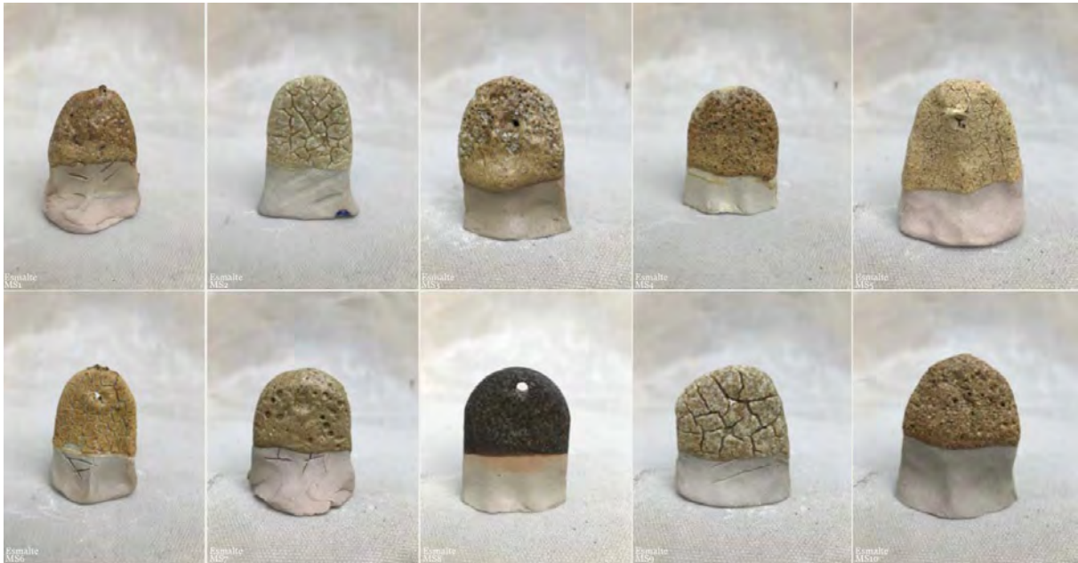
Figura 17. Resultados de las fórmulas experimentales con tierras del Morro Solar
