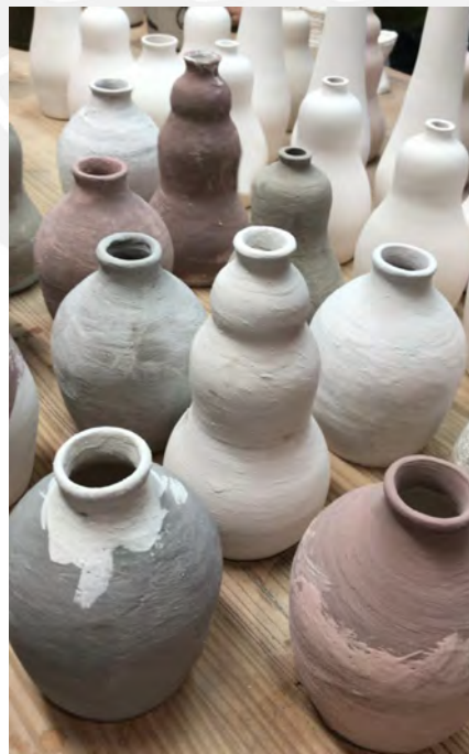
Figura 5. Esmaltes en piezas bizcochadas
