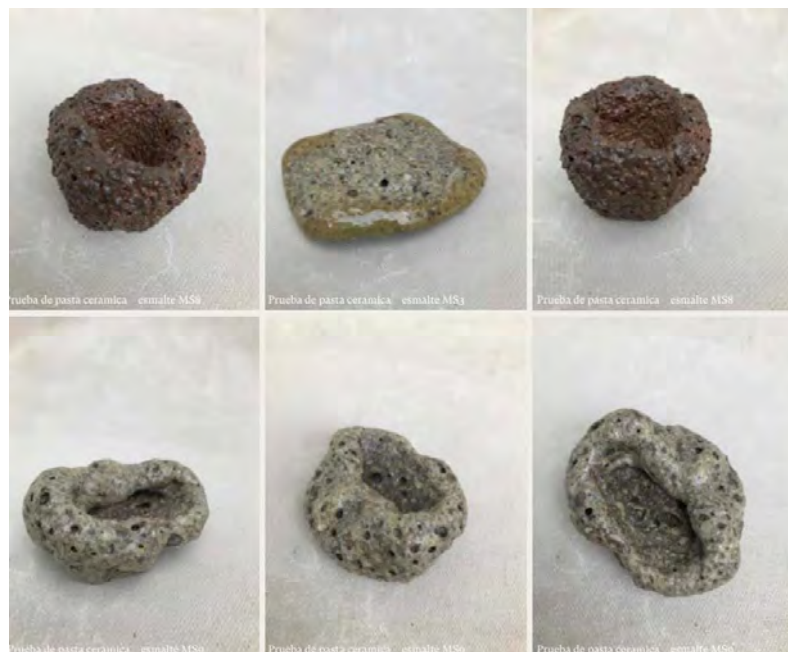
Figura 18. Experimentaciones de tierras del Morro Solar con pasta cerámica
