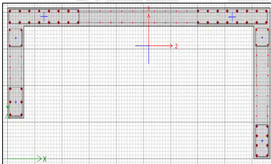
Figura 37. Detalle de refuerzo a flexocompresión de la placa PL-01
