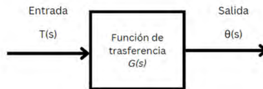
Figura 4.3: Función de transferencia que relaciona la salida del desplazamiento angular ( \theta(s) ) de flexión-extensión de la mano y la entrada del torque del temblor ( T(s) ) de Parkinson.
