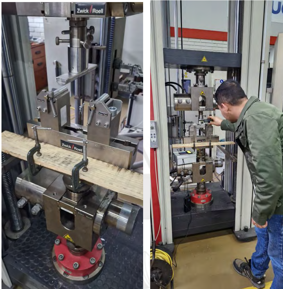
Figura 5.6 Preparación del equipo de Zwick Roell Z250
