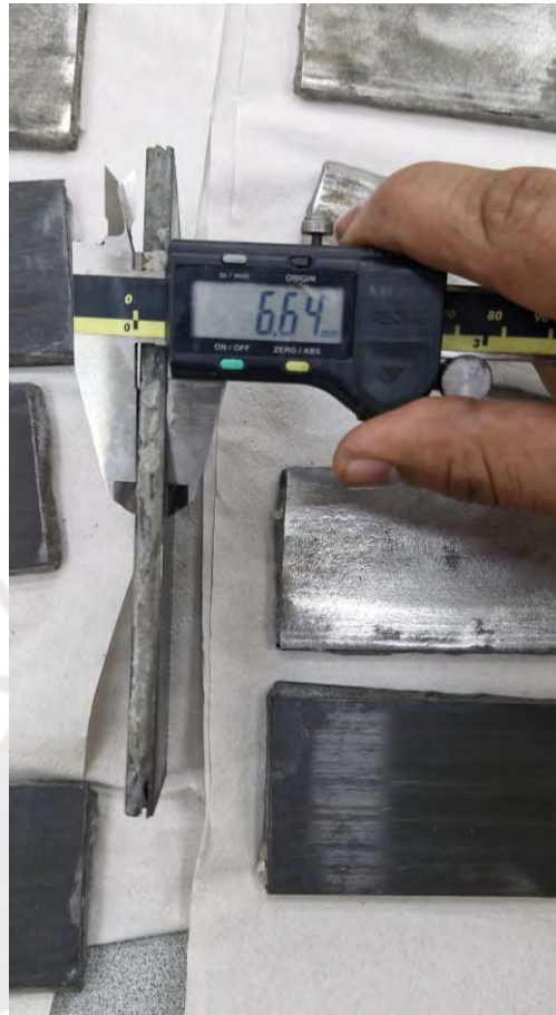
Figura 7.2 Control dimensional de las probetas post secado.
