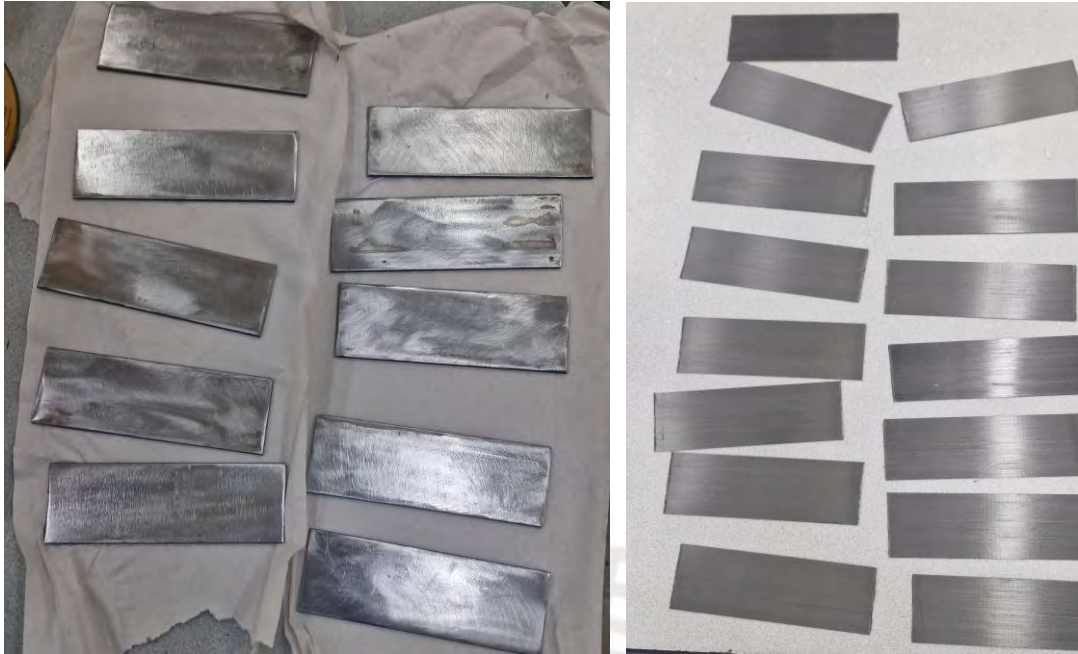
Figura 5.2 Habilitado y pulido de platinas de acero A36 y láminas de CFRP carbodur S512.
