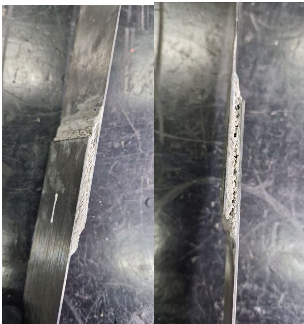
Figura 5.25 Ensayo de corte: probeta 1 – modo de falla mixta (adhesivo y cohesivo).
