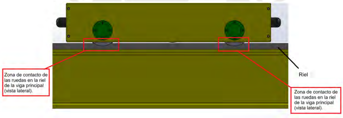
Figura 4.2 Zona de contacto de las ruedas y la viga principal del puente grúa birriel.
