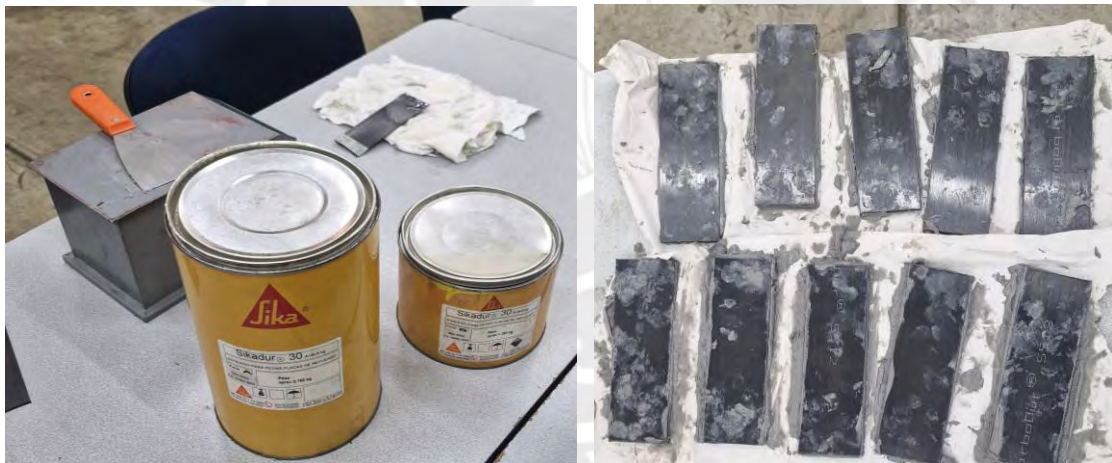
Figura 5.3 Preparación del adhesivo sikadur30 y pegado de las platinas de acero y láminas de carbodur S512.
