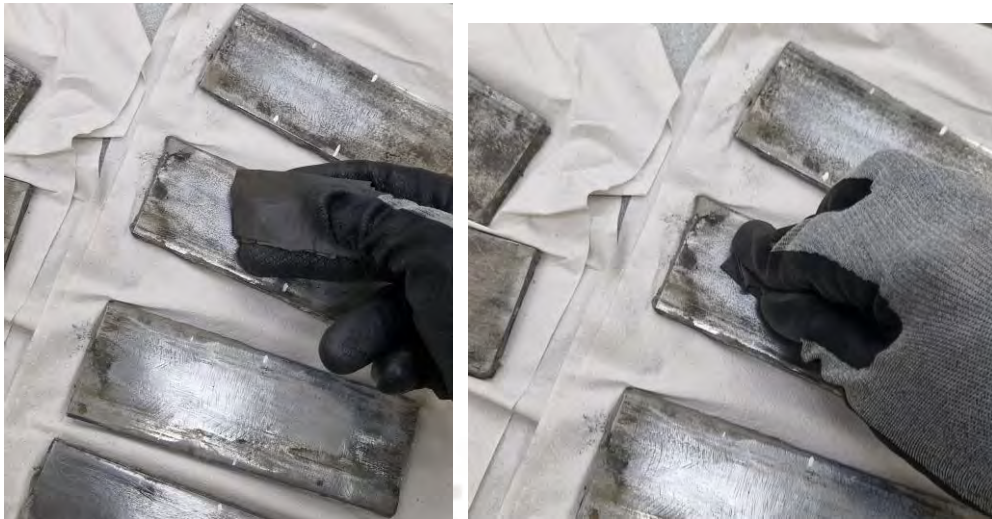
Figura 7.4 Lijado y limpieza de las zonas marcadas para el pegado de las galgas extensiométricas.
