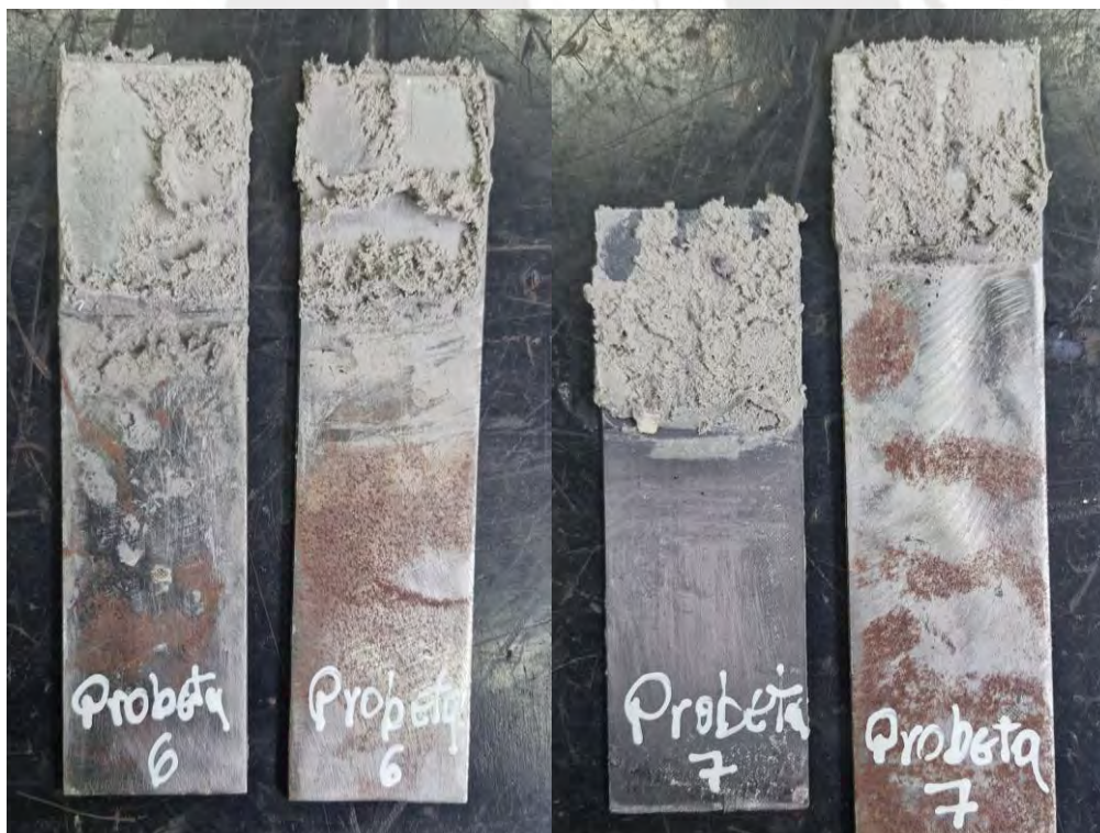
Figura 5.28 Ensayo de corte: probeta 6 modo de falla cohesiva - probeta 7 modo de falla mixta (adhesivo y cohesivo).
