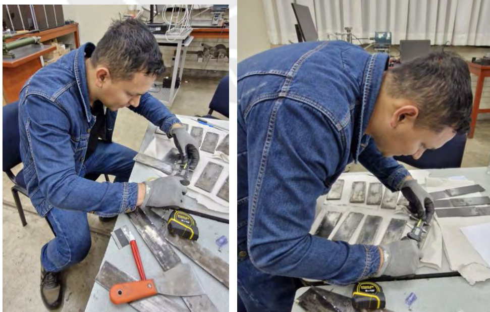
Figura 7.3 Marcado de las zonas de pegado de las galgas extensiométricas.
