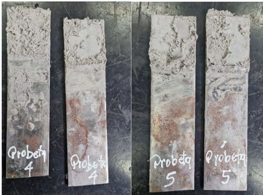
Figura 5.27 Ensayo de corte: probeta 4 y 5 – modo de falla cohesiva.
