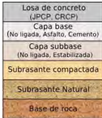
Figura 2.2: Componentes básicos de un sistema típico de pavimento, adaptado del trabajo de FHWA (FHWA, 2017).
