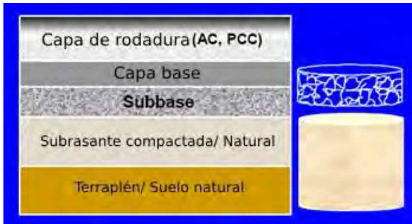
Figura 2.1: Componentes básicos de un sistema típico de pavimento, adaptado del trabajo de Federal Highway Administration (FHWA) (FHWA, 2017).
