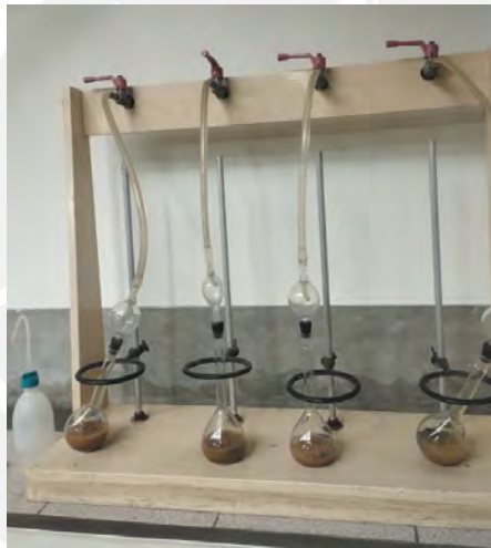
Figura 5.11: Picnómetros en la bomba de vacío para extraer el aire (Fuente: propia).
