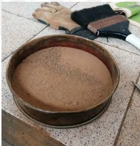
Figura 5.6: Muestra que pasa la malla N° 10 para lavar (Fuente: propia).
