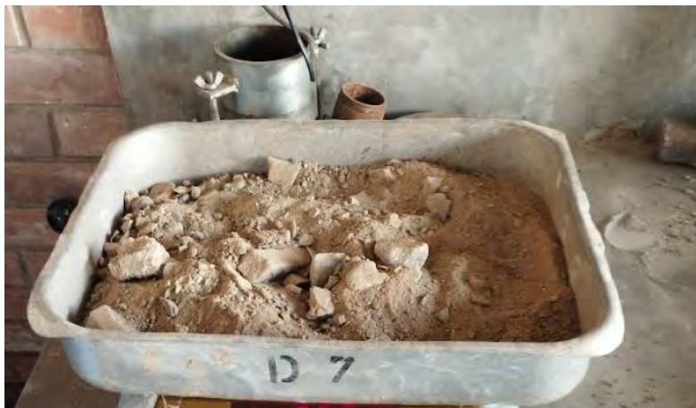
Figura 5.5: Separación de muestra para Granulometría (Fuente: propia).
