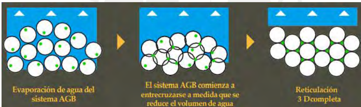
Figura 2.7: Proceso de reticulación de las partículas de un suelo (Aggrebind, 2020).
