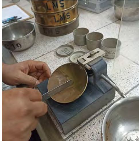
Figura 5.8: Ensayo de límite líquido (Fuente: propia).
