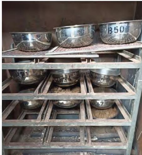
Figura 5.7: Muestras en el horno para el ensayo de humedad (Fuente: propia).
