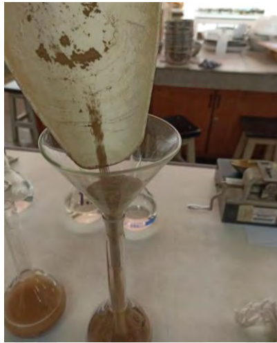
Figura 5.10: Colocación de suelo en el picnómetro con agua para el ensayo de G_s (Fuente: propia).
