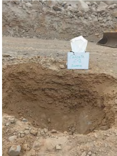
Figura 5.3: Recolección de muestra de calicata 2 (Fuente: propia).
