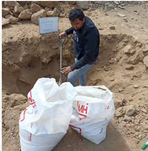
Figura 4.2: Excavación de calicata y recolección de muestra (Fuente: propia).
