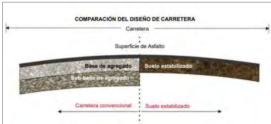
Figura 2.4: Carretera convencionalmente construida versus carretera estabilizada con AggreBind RM1 (Abd, 2023).
