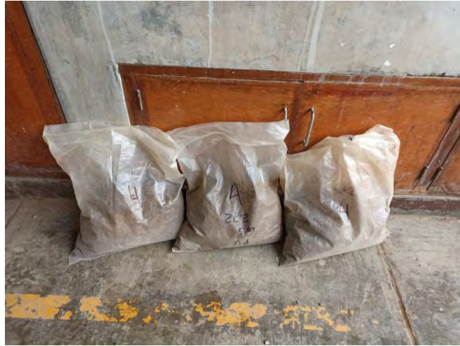
Figura 4.6: Muestras preparadas para ensayo CBR (Fuente: propia).
