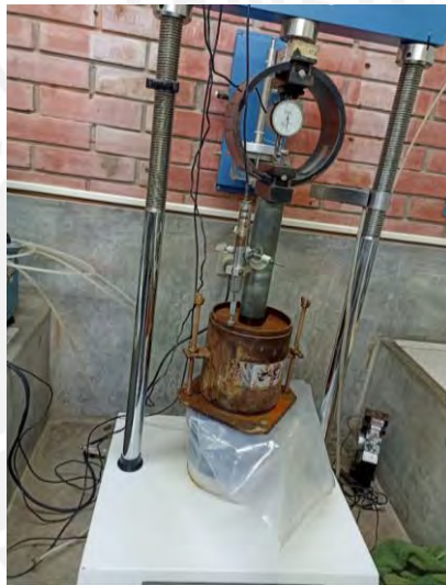
Figura 4.7: Prensa de carga para el ensayo CBR (Fuente: propia).
