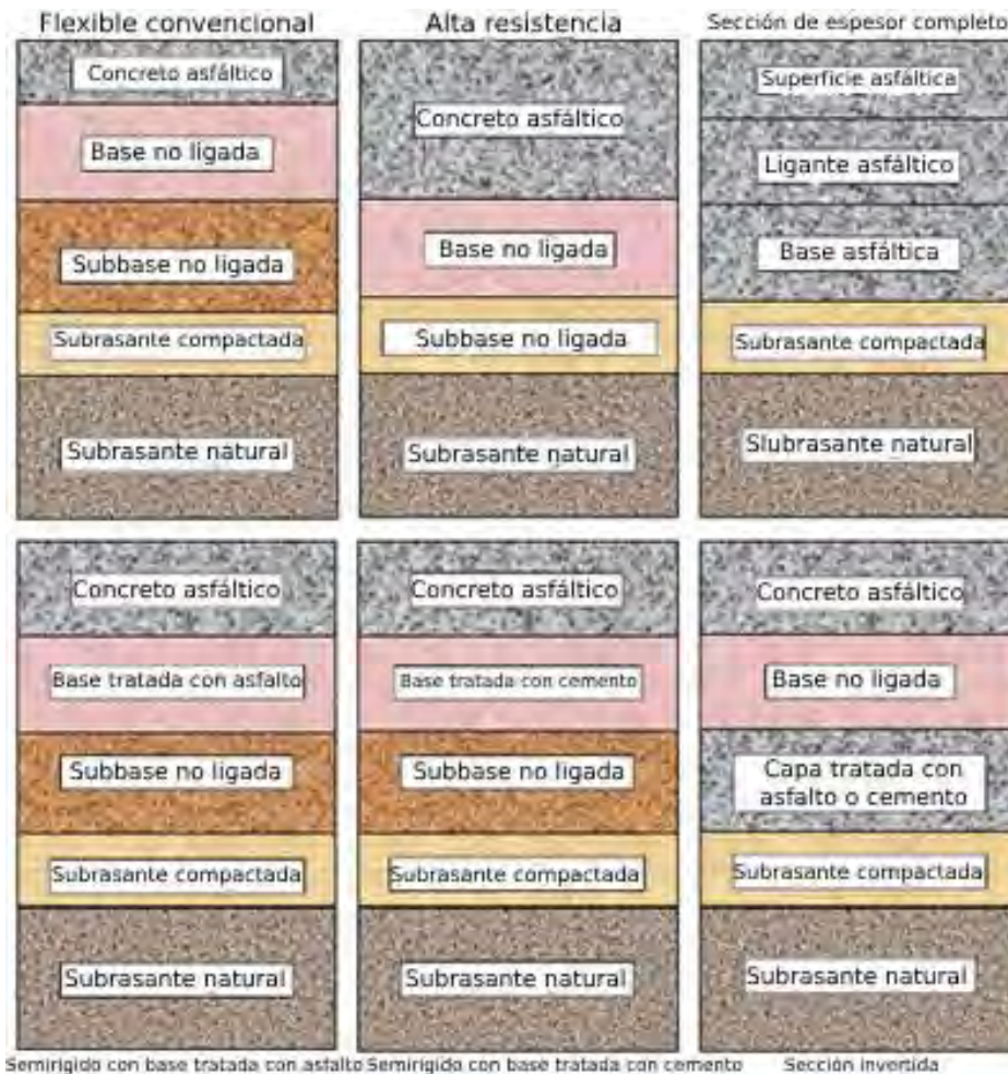
Figura 2.3: Algunas variaciones comunes del sistema de pavimento flexible, adaptado del trabajo de FHWA (FHWA, 2017).
