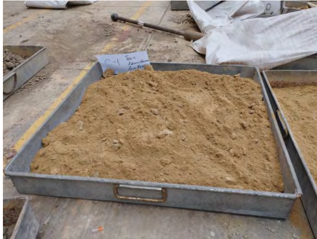
Figura 4.4: Secado al aire de las muestras (Fuente: propia).
