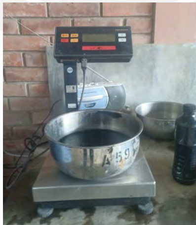
Figura 4.5: Mezcla líquida de polímero de estireno acrílico con agua (Fuente: propia).
