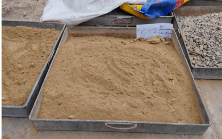
Figura 5.4: Secado al aire para el cuarteo (Fuente: propia).
