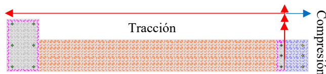
Figura 4.28 - Sección y esfuerzos del muro X1 (positivo).
