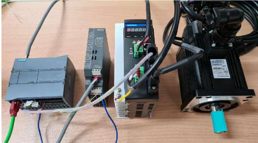
Figura 7.4: Componentes funcionamiento Servomotor ADTECH
