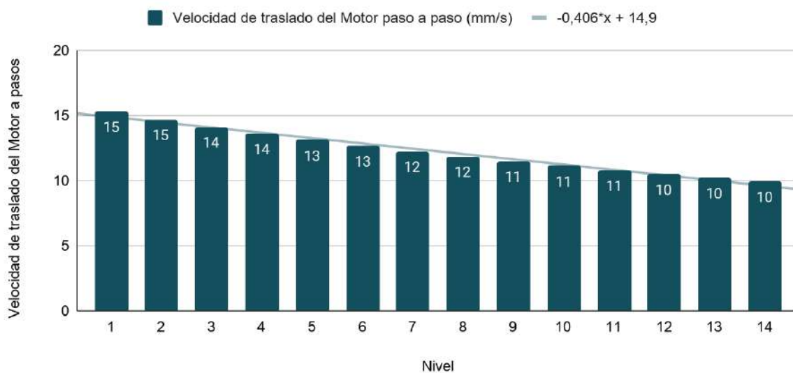
Velocidad de traslado del Motor paso a paso (mm/s) frente a Nivel
