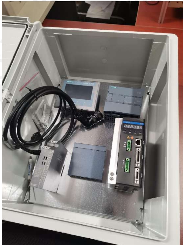
Figura 7.6: Componentes electrónica Subsistema WGC
