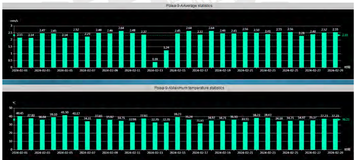
Figura 5.9: Monitoreo de vibración y temperatura lado izquierdo de la polea N°9 A lado cola de la faja transportadora de mineral 014003
