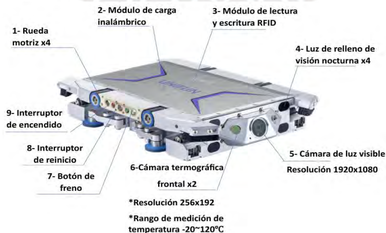
Figura 4.5: Composición estructural del robot móvil de monitoreo de faja transportadora de mineral.
