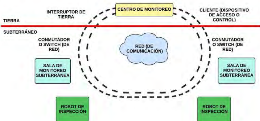
Figura 2.5: La arquitectura de red del sistema de monitoreo de cinta transportadora
