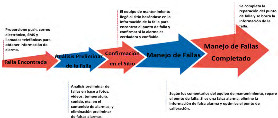
Figura 4.22: Gestión de operación del sistema de monitoreo inteligente de detección y diagnóstico de fallas.
