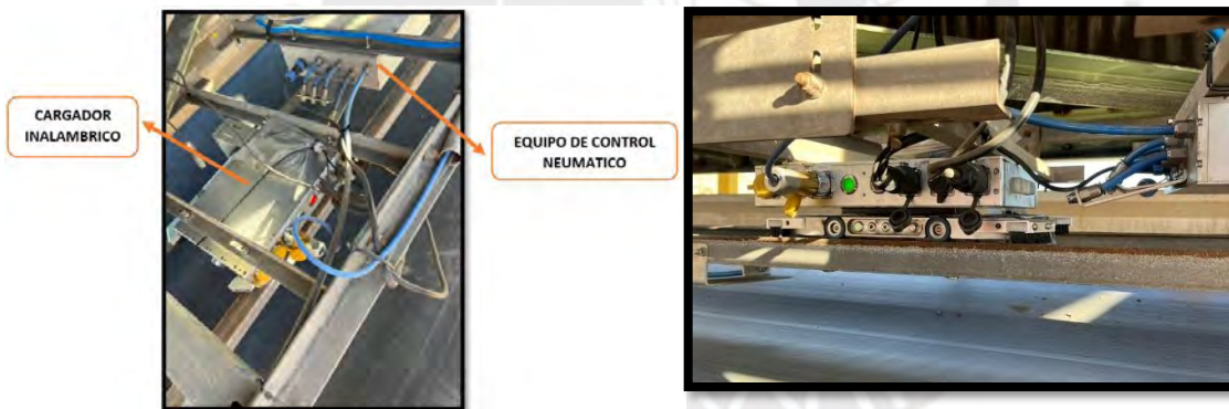
Figura 4.18: Lado izquierdo vista de planta y lado derecho vista frontal del sistema de carga y limpieza del robot móvil.
