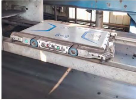
Figura 4.9: Se Muestra el robot móvil instalado en el riel para sus pruebas de traslación.
