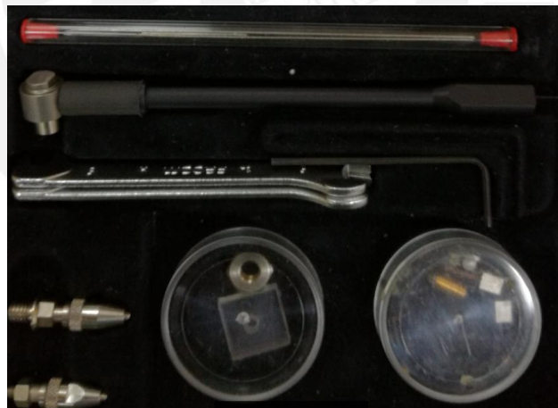
Figura 42: Martillo de impacto tipo 8203 marca Brüel & Kjær
