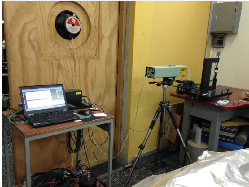
Figura 40: Banco de ensayos de amortiguamiento
