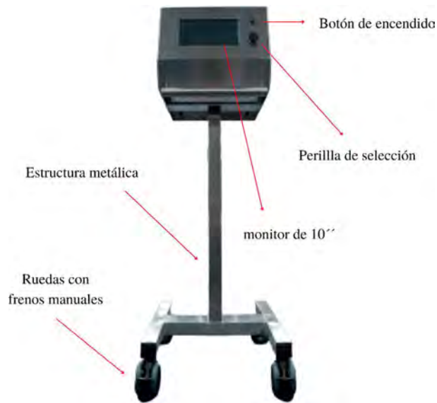
Figura 3.3: Partes principales del ventilador mecánico Masi
