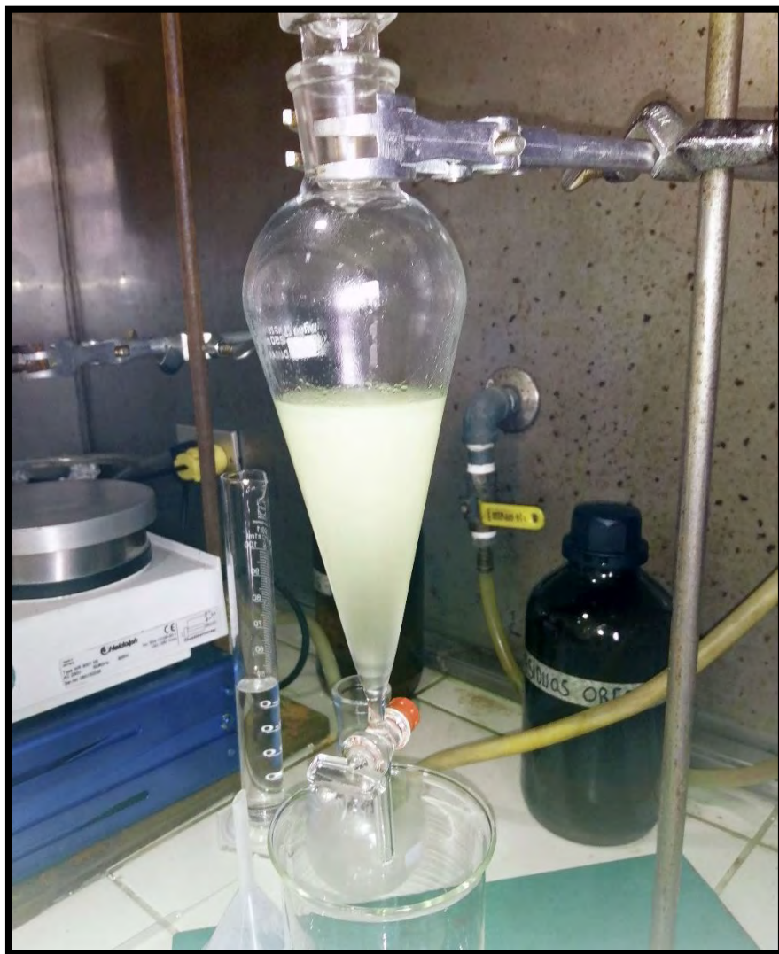
Fotografía 4. Lavado del telequímico con solución acuosa saturada de NaCl después de la síntesis
