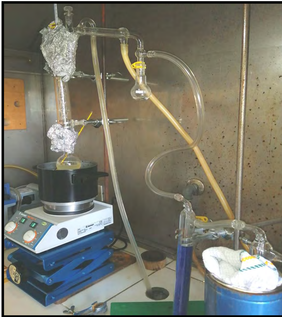
Fotografía 1. Destilación del monómero 2-etil-2-oxazolina (Etoxa) Laboratorio de Polímeros Sección Física PUCP
