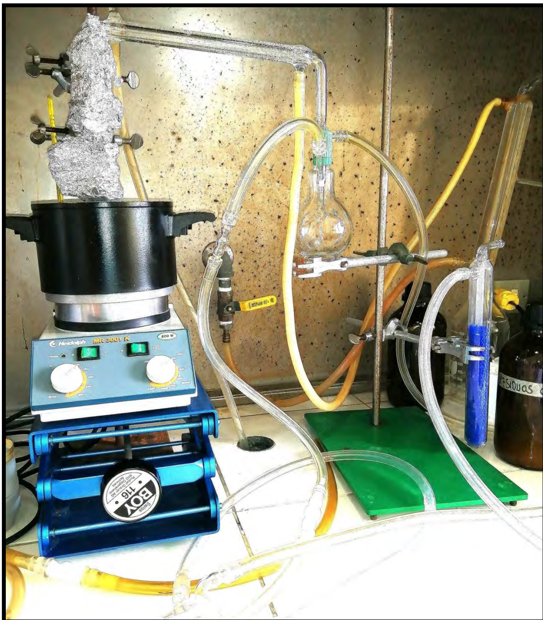
Fotografía 2. Destilación al vacío del monómero 2-metoxicarboniletil-2-oxazolina (Esteroxa)
