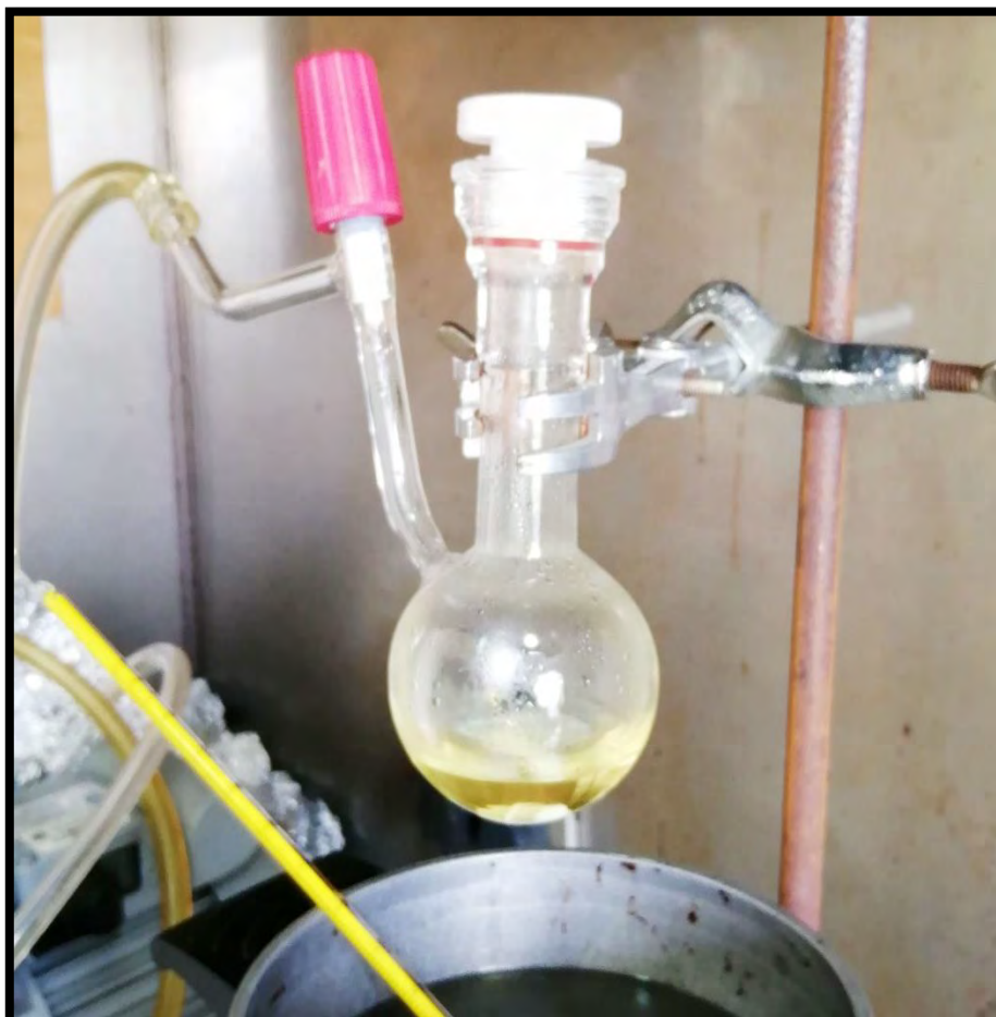
Fotografía 3. Reactor para la síntesis de telequímicos
