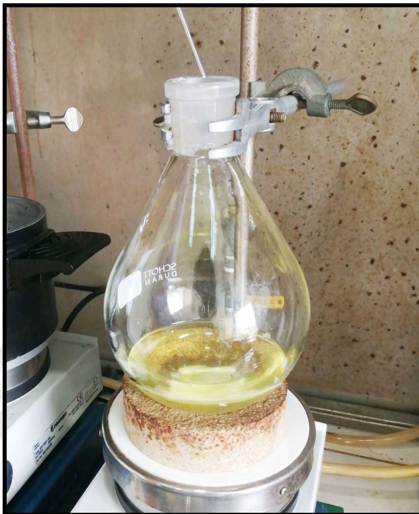
Fotografía 6. Purificación del etil xantato de potasio
