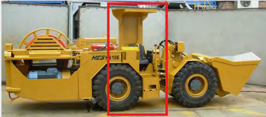
Figura 43. Identificación de la cabina del operador
