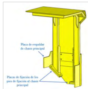
Figura 60. Modelo simplificado 3D para simulación FOPS
