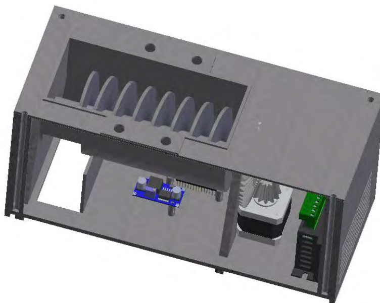
Figura 41. Dosificador del alimento – vista de corte para ver componentes
