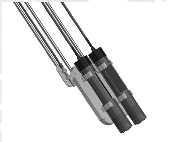
Figura 21. Imagen de cómo se sostienen las sondas
