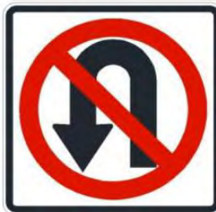
Figura 36: Señal de prohibido voltear en U
